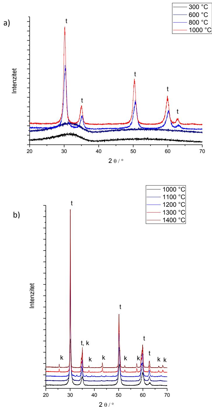
**Slika 12.** Difraktogrami uzorka sgA20 kristaliziranog a) do 1000 °C i b) iznad 1000 °C;
