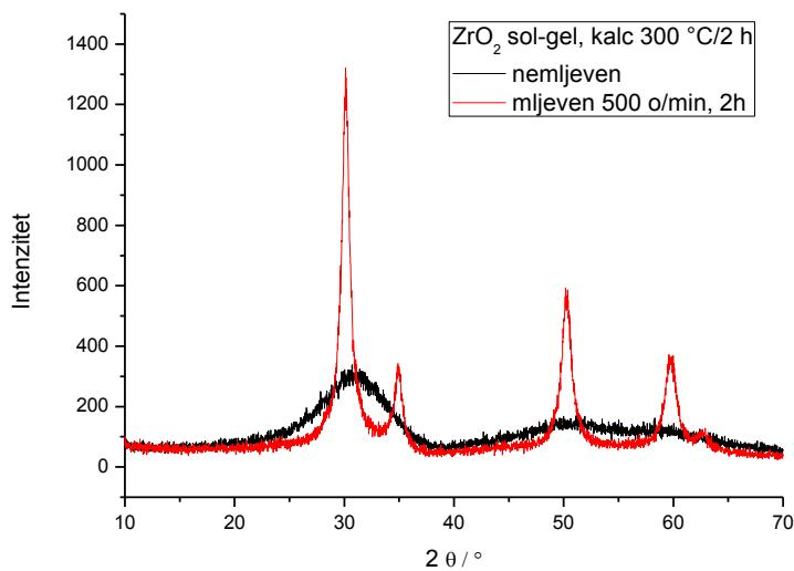
**Slika 9.** Difraktogram uzoraka sgZY i sgZYm žarenih na  $300\text{ }{}^\circ\text{C}$
