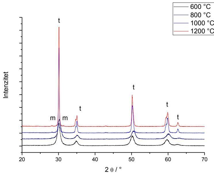
**Slika 10.** Difraktogram uzorka sgZYm; t – t-ZrO<sub>2</sub>, m – m-ZrO<sub>2</sub>
