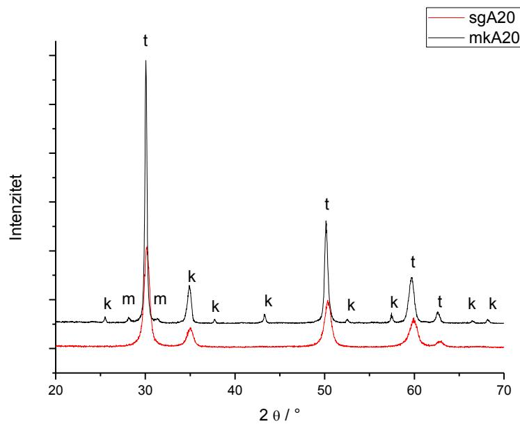
**Slika 18.** Difraktogrami prašaka mkA20 i sgA20 kalciniranih na 1000 °C; t – t-ZrO<sub>2</sub>,
