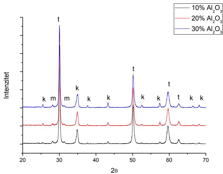
**Slika 17.** Difraktogrami prašaka mkA10, mkA20 i mkA30 kalciniranih na 1000 °C;
