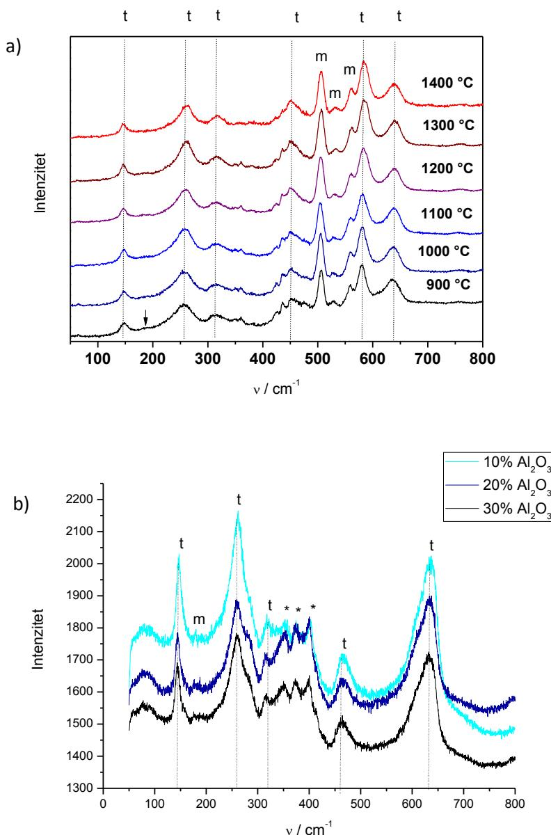
**Slika 19.** Ramanovi spektri: a) uzorka sgZYm kalciniranog na navedenim temperaturama i b) uzoraka mkA10, mkA20 i mkA30 žarenih na 1400 °C; t – t-ZrO<sub>2</sub>, m – m-ZrO<sub>2</sub>, \* – nečistoće
