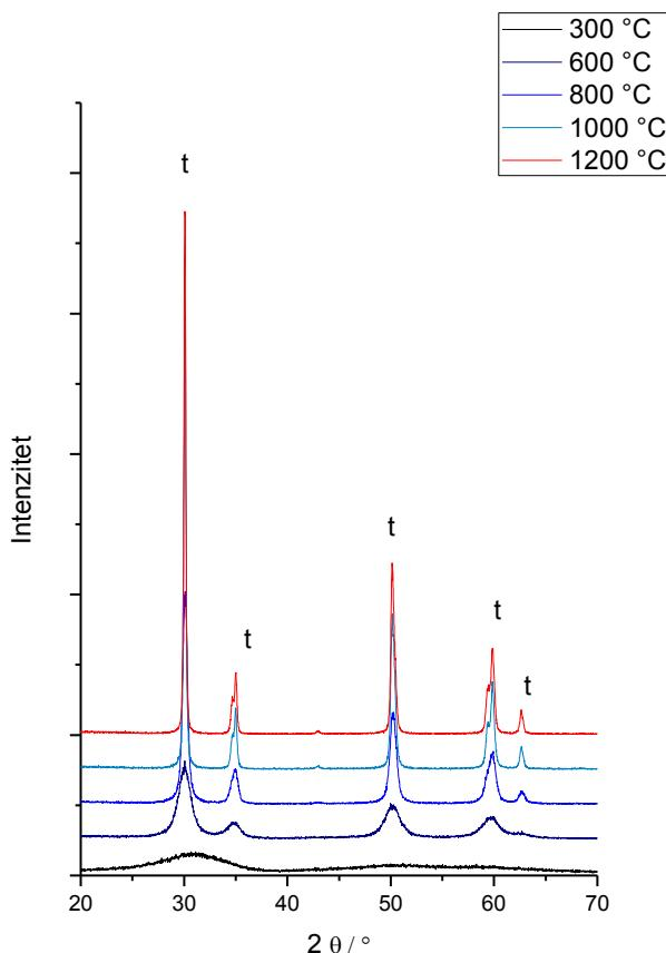
**Slika 8.** Difraktogram uzorka sgZY; t – t-ZrO<sub>2</sub>
