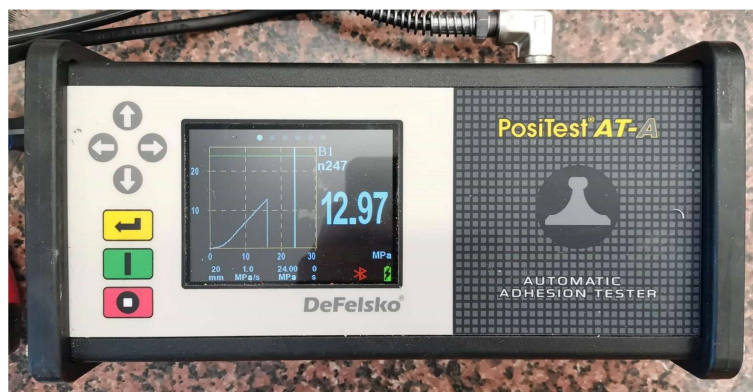
Slika 3.11 Uređaj PosiTest ATA za ispitivanje prionjivosti vlačnom metodom
