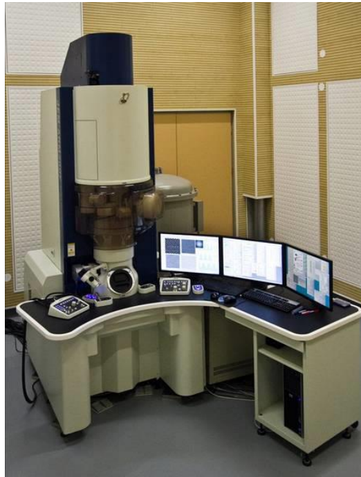
Slika 8. Transmisijski elektronski mikroskop atomske rezolucije, ARM 200 CF, JEOL, korišten za mikrostrukturnu karakterizaciju uzoraka u ovom radu. Uređaj se nalazi na Kemijskom institutu u Ljubljani.
