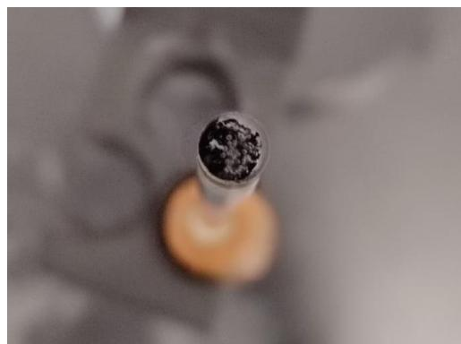
Slika 24. Mjeđu nastali na elektrodi s 20  $\mu\text{L}$  disperzije MWCNT i 30  $\mu\text{L}$  membrane
