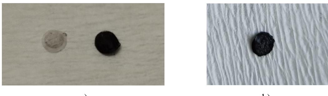
Slika 25. a) Dobro napravljena membrana bez i sa čvrstim kontaktom, b) membrana i čvrsti kontakt kroz koji su prodrijeli mjeđu
