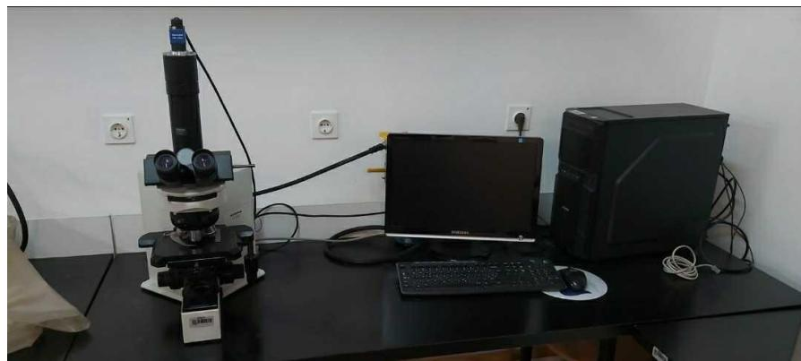
**Slika 10.** Svjetlosni mikroskop opremljen kamerom za snimanje mikrofotografija.
