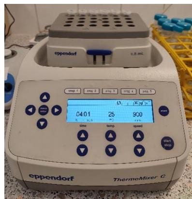
Slika 3.2. Termostatirana tresilica *Eppendorf ThermoMixer C*
