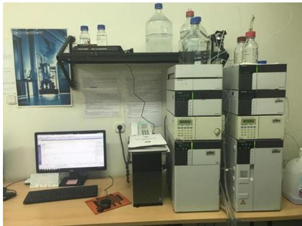
Slika 3.4. HPLC instrument *SHIMADZU*
