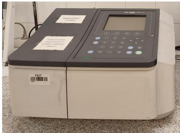
Slika 3.5. Spektrofotometar *Shimadzu UV-1800*
