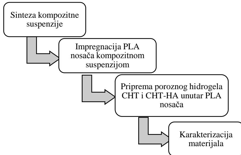
Slika 6. Shematski prikaz tijeka priprave poroznih kompozitnih nosača.
