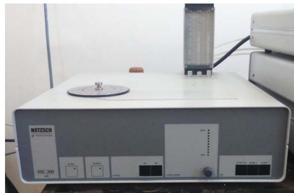
Slika 10. Diferencijalni pretražni kalorimetar.
