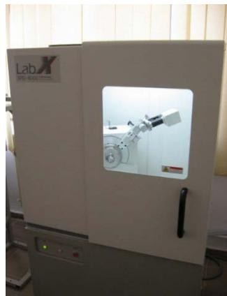
Slika 8. XRD difraktometar.
