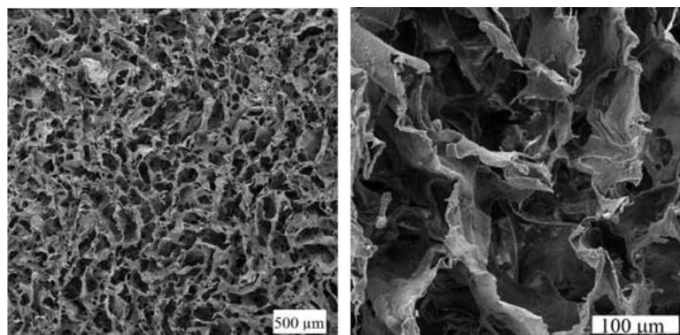
Slika 4. Visokoporozni nosač kitozan/hidroksiapatit.
