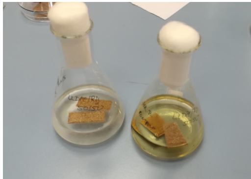
Slika 22 . Uzorci u hranjivim podlogama pripremljeni za proces biorazgradnje
