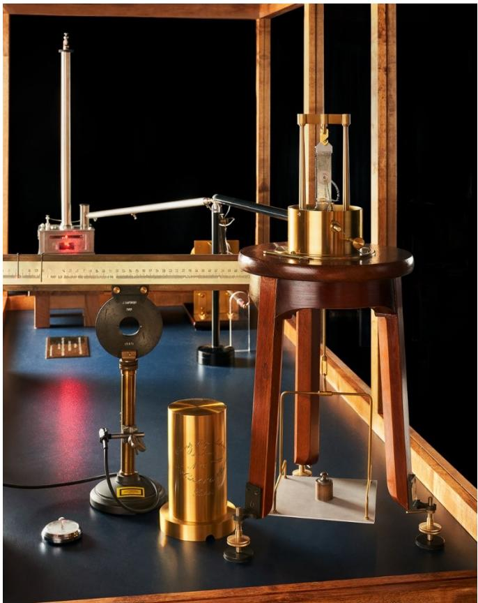
Slika 4. elektrometar s piezoelektričnim kvarcom i osjetljivim vagama<sup>21</sup>
