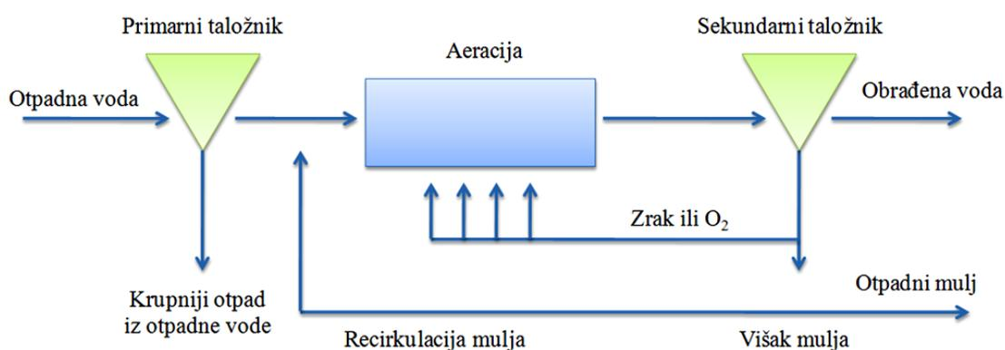
Slika 2.3. Klasični postupak obrade otpadne vode aktivnim muljem.
