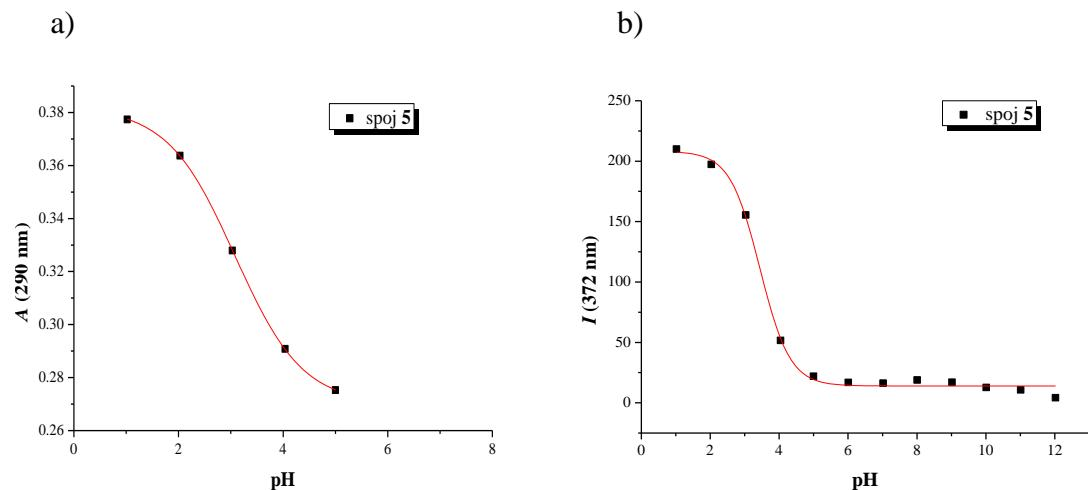
**Slika 22.** a) ovisnost apsorbancije na valnoj duljini od 290 nm o vrijednosti pH za spoj 5;
