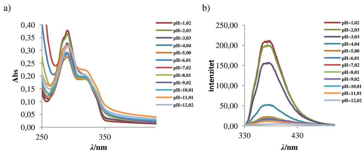
**Slika 21.** a) apsorpcijski spektri; b) emisijski spektri spoja **5** u otopinama univerzalnog pufera različitih vrijednosti pH
