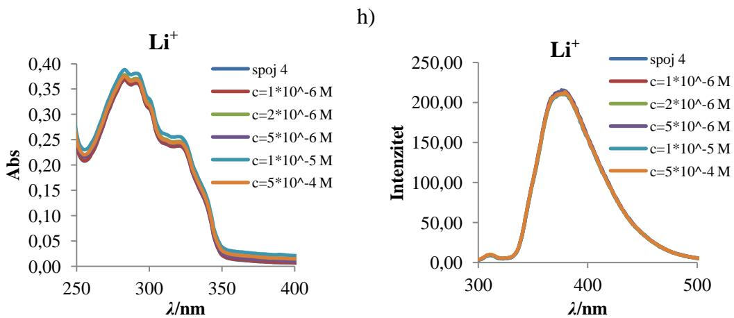
Slika 25. Apsorpcijski i emisijski spektri različitih koncentracija metalnih iona a)  $\text{Cu}^{2+}$ ; b)  $\text{Hg}^{2+}$ ; c)  $\text{Zn}^{2+}$ ; d)  $\text{Al}^{3+}$ ; e)  $\text{Fe}^{3+}$ ; f)  $\text{Ca}^{2+}$ ; g)  $\text{Ag}^+$  i h)  $\text{Li}^+$  za spoj 4,  $c = 1 \cdot 10^{-5} \text{ M}$
