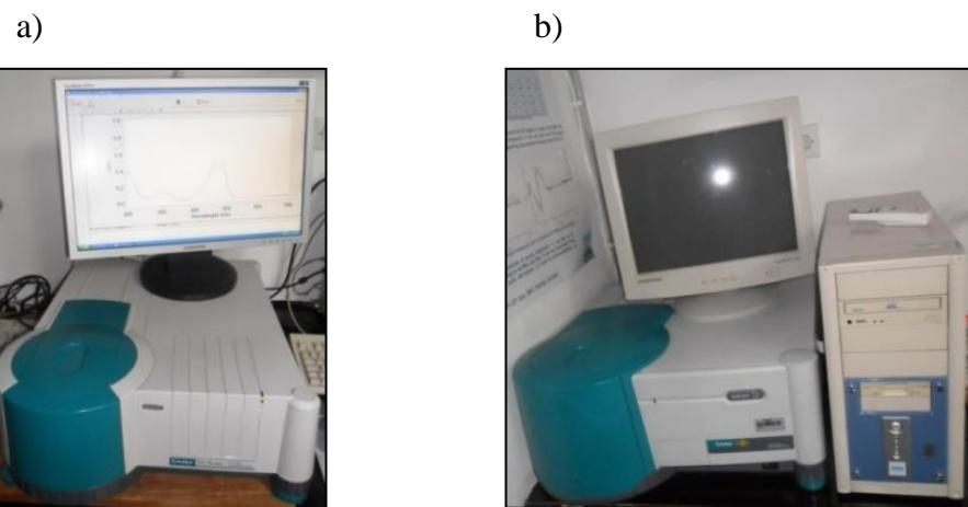
**Slika 15.** a) UV-vidljivi apsorpcijski spektrofotometar; b) fluorescencijski spektrofotometar
