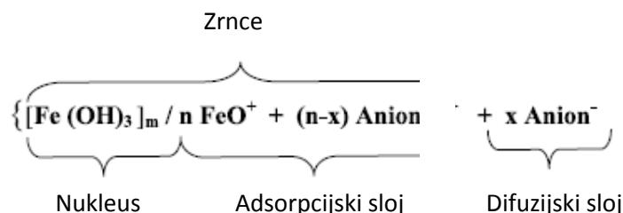
Slika 2.9. Koloidna čestica željeznog hidroksida
