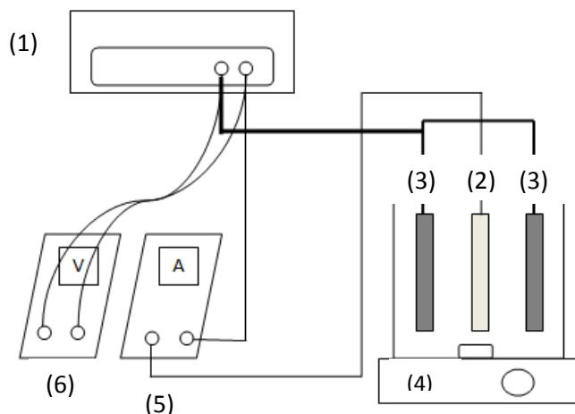
Slika 3.8. Skica aparature za elektrokoagulaciju: (1) izvor struje, (2) radna elektroda, (3) protuelektrode, (4) magnetsko miješalo, (5) ampermetar, (6) voltmetar
