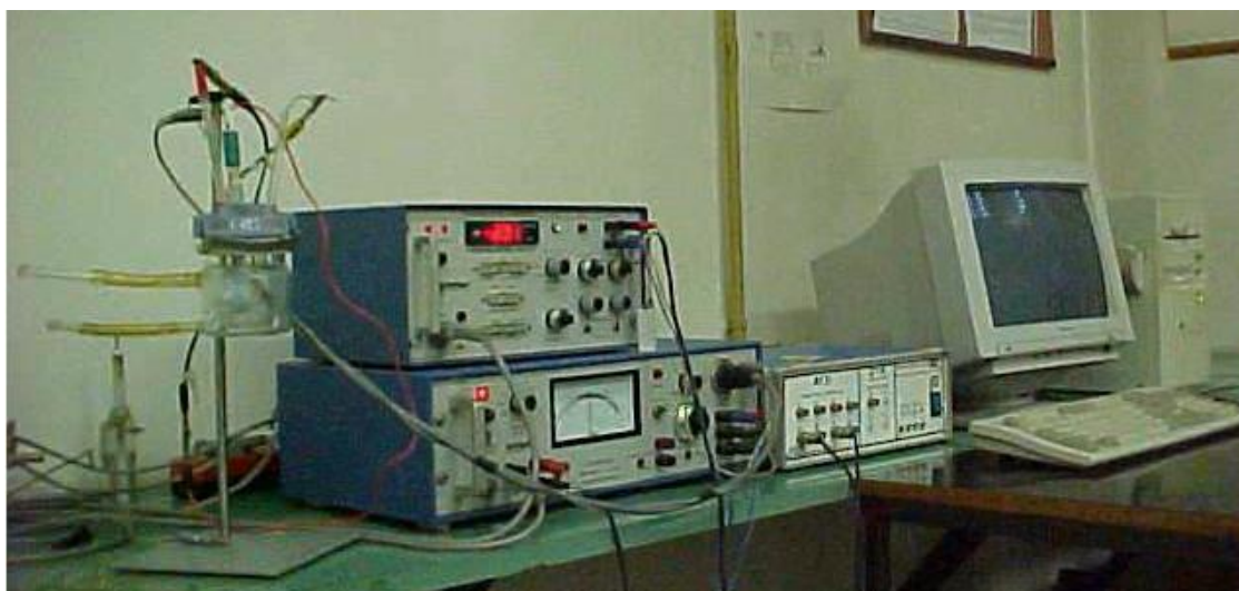
Slika 3.9. Aparatura za provedbu elektrokemijskih mjerenja u troelektrodnom sustavu
