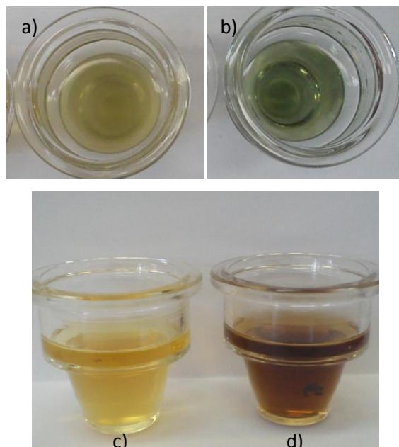
Slika 5.4. Otopina ELM kod: a) pH=6, b) pH=9, c) pH=6 (dodatak  $\text{Fe}^{3+}$ ), d) pH=9 (dodatak  $\text{Fe}^{3+}$ ).
