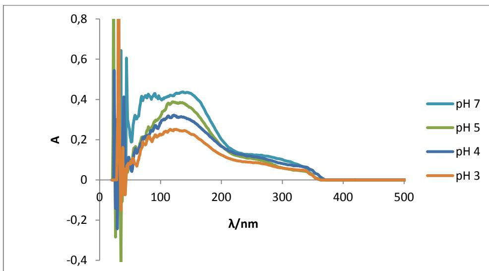
Slika 3.4. Prikaz ovisnosti apsorbancije o valnoj duljini za uzorke OMW-a koji su tretirani uz dodatak soli kod različitih pH-vrijednosti
