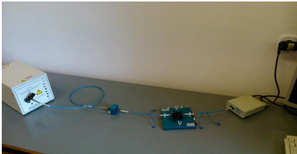
Slika 3.7. UV/Vis spektrofotometar
