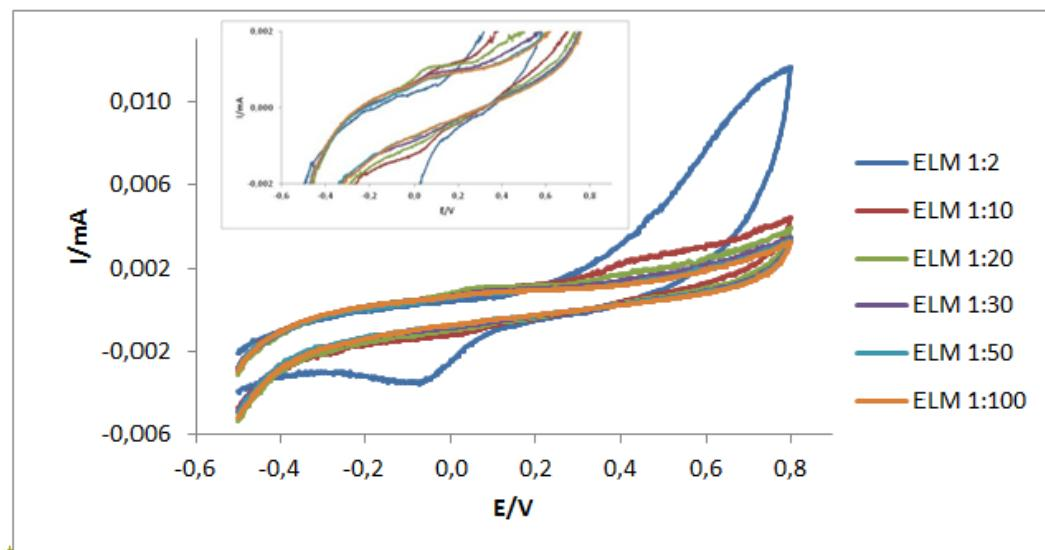
Slika 4.1. Ciklički voltamogram snimljen na elektrodi od staklastog ugljika uronjenoj u otopine različitih koncentracija ekstrakta lista masline u 0,25 mol dm<sup>-3</sup> NaCl pri brzini promjene potencijala 50 mV s<sup>-1</sup>
