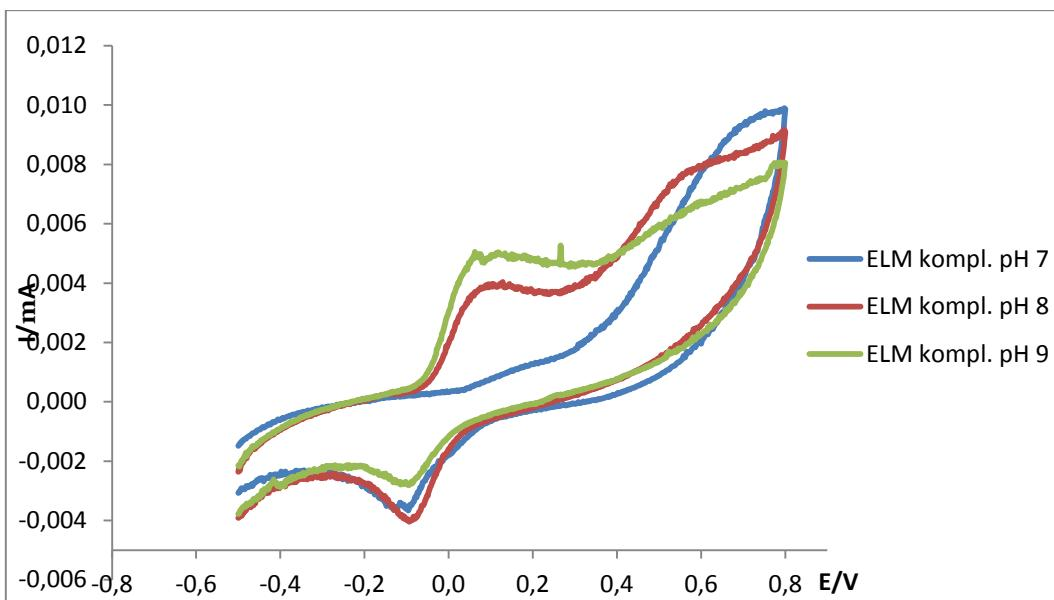
Slika 4.4. Ciklički voltamogram snimljen na GC elektrodi uronjenoj u otopine ekstrakta lista masline uz dodatak  $\text{FeCl}_3$ , ( $c=3,36 \times 10^{-4} \text{ mol L}^{-1}$ ) kod različitih pH vrijednosti pri brzini promjene potencijala  $50 \text{ mV s}^{-1}$
