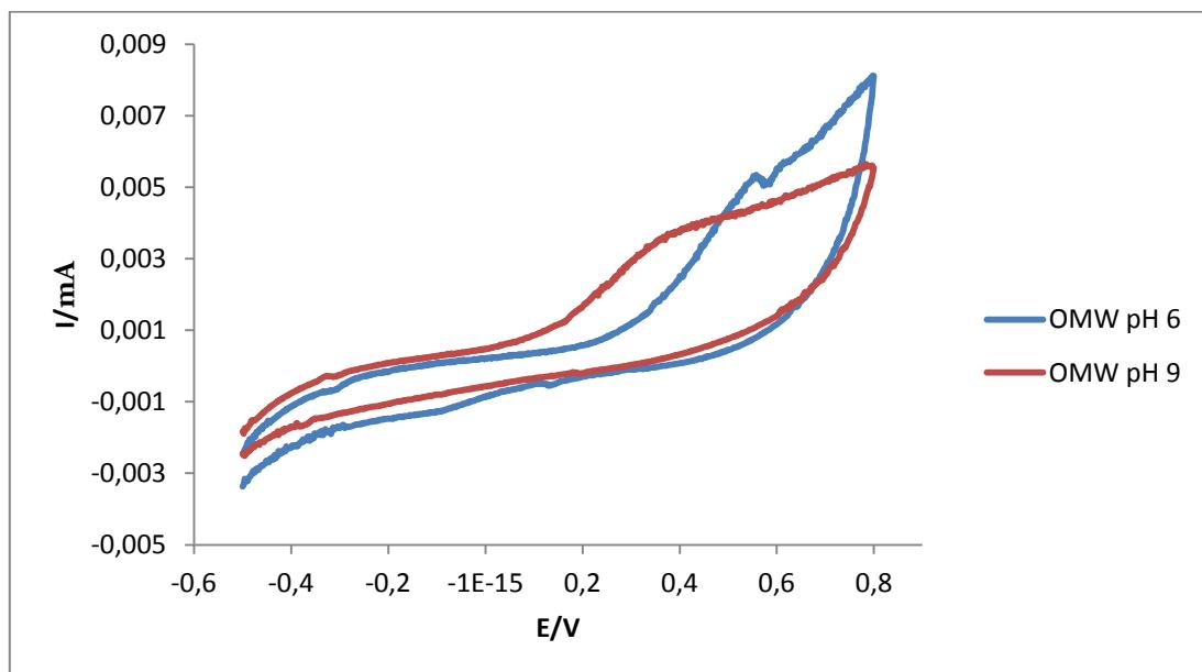
Slika 4.5. Ciklički voltamogram snimljen na GC elektrodi uronjenoj u otopine OMW-a bez dodatka  $\text{FeCl}_3$  kod različitih pH vrijednosti pri brzini promjene potencijala  $50 \text{ mV s}^{-1}$
