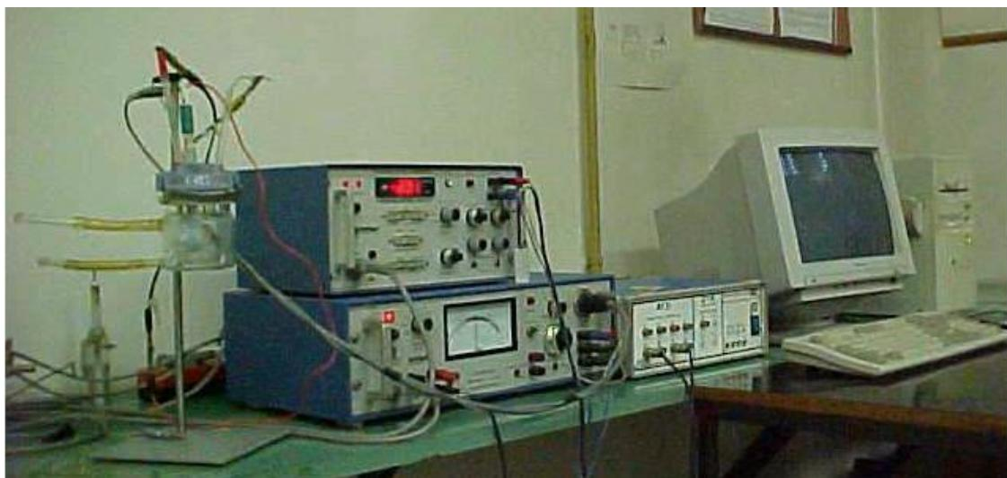
Slika 3.9. Aparatura za provedbu elektrokemijskih mjerena u troelektrodnom sustavu
