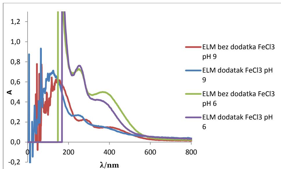
Slika 4.6. Prikaz ovisnosti apsorbancije o valnoj duljini za otopinu ekstrakta lista masline bez dodatka i uz dodatak FeCl<sub>3</sub> kod različitih pH vrijednosti
