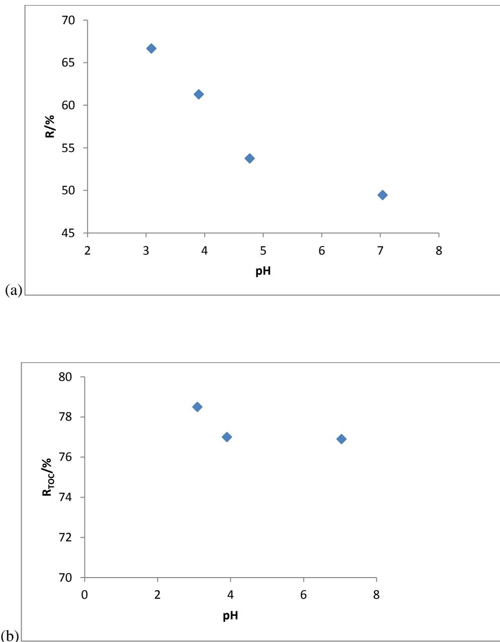
Slika 5.1. Grafički prikaz ovisnosti učinkovitosti uklanjanja a) fenolnih spojeva, b) ukupnog organskog ugljika(TOC) iz vegetacijskih otpadnih voda u ovisnosti o pH vrijednosti pri trajanju procesa 60 min
