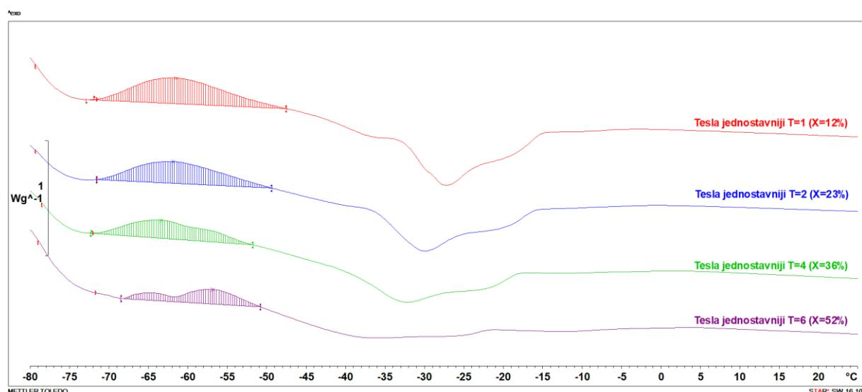
**Slika 32.** Egzotermska promjena za uzorak iz reaktora s jednostavnijim Teslinim strukturama pri svim vremenima zadržavanja
