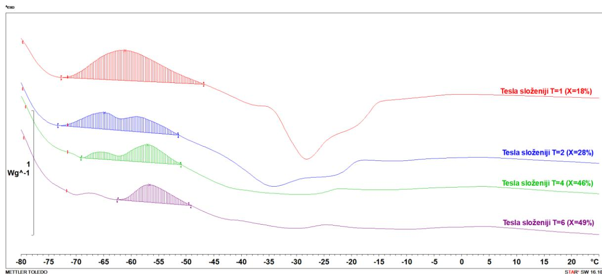
**Slika 31.** Egzotermska promjena za uzorak iz reaktora sa složenijim Teslinim strukturama pri svim vremenima zadržavanja
