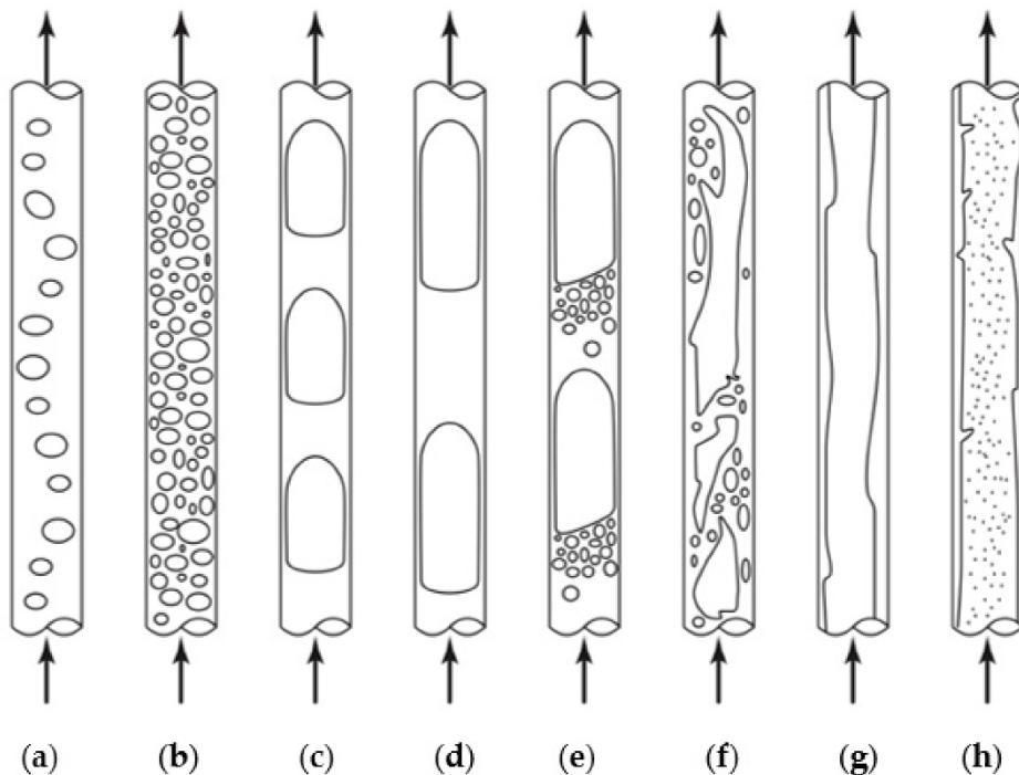
**Slika 4.** Strujanje fluida u mikrokanalima: (a,b) mjehuričasto strujanje, (c,d) segmentirano (Taylorovo) strujanje, (e) prijelazno segmentirano-uzburkano strujanje, (f) uzburkano strujanje, (g) strujanje u filmu, (h) anularno strujanje<sup>25</sup>
