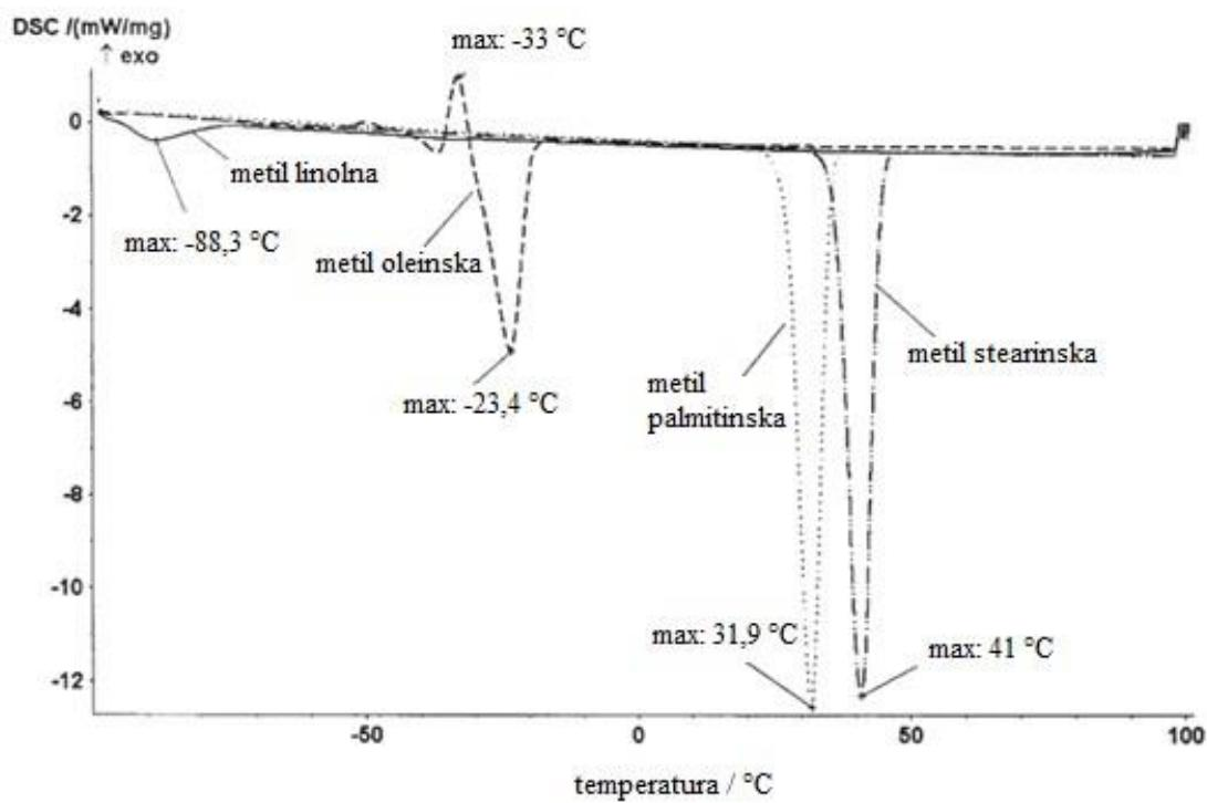
**Slika 25.** Rezultat DSC analize metilnih estera masnih kiselina dobivenih iz suncokretovog ulja<sup>37</sup>
