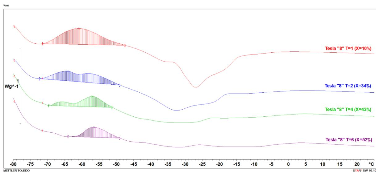
**Slika 33.** Egzotermna promjena za uzorak iz reaktora s Teslinim strukturama oblika „osmice“ pri svim vremenima zadržavanja
