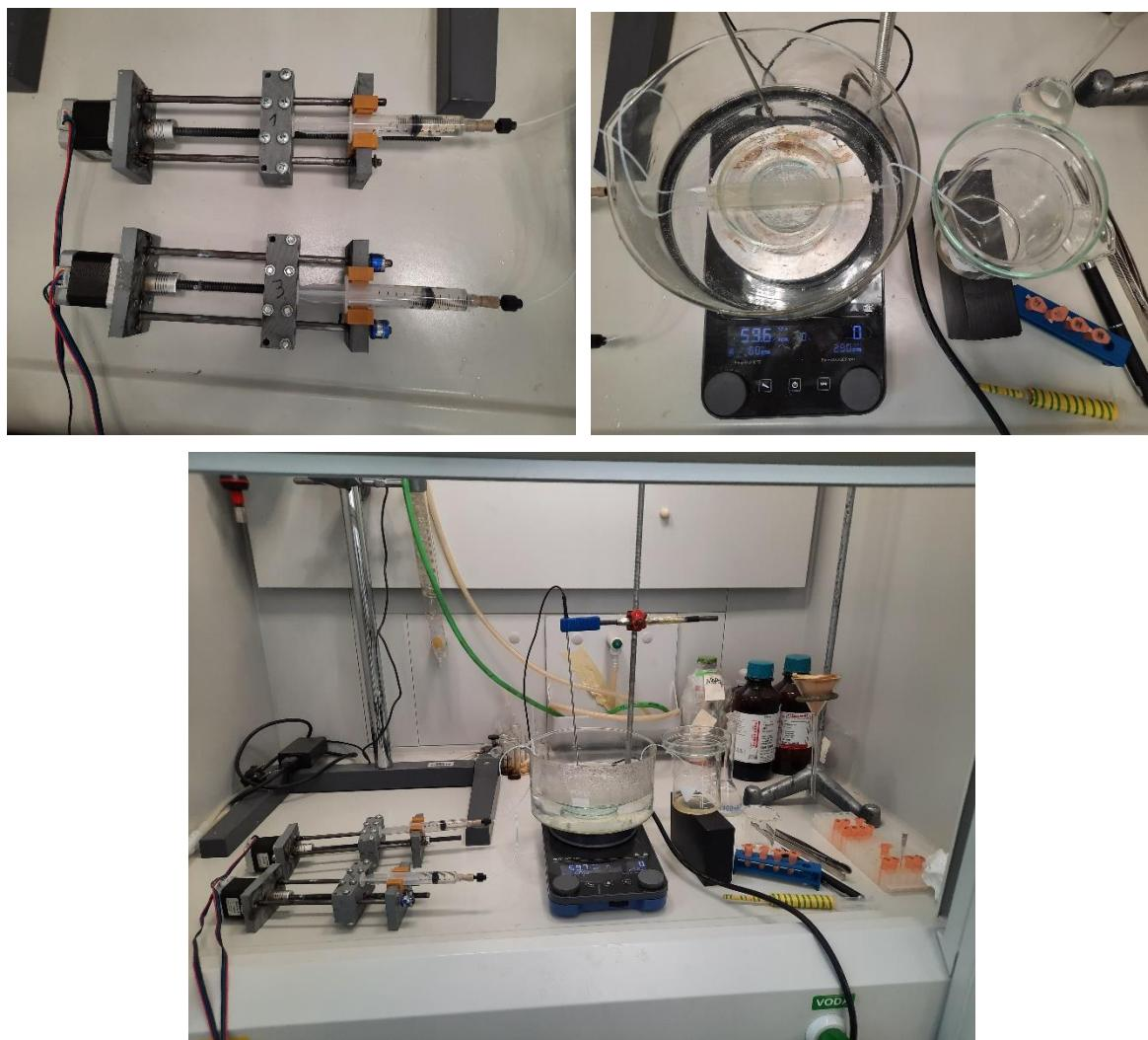
**Slika 9.** Aparatura za provođenje reakcije sinteze biodizela
