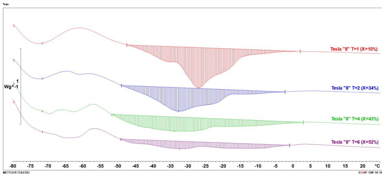
**Slika 38.** Endotermna promjena za uzorak reaktora s Teslinim strukturama oblika „osmice“
