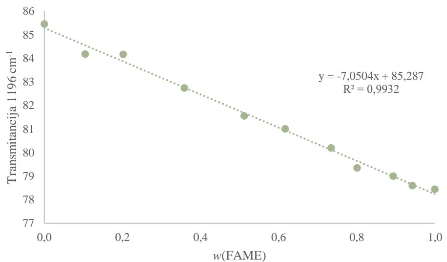
**Slika 12.** Baždarni dijagram ovisnosti transmitancije o udjelu biodizela za vrpcu s vrhom na  $1196 \text{ cm}^{-1}$
