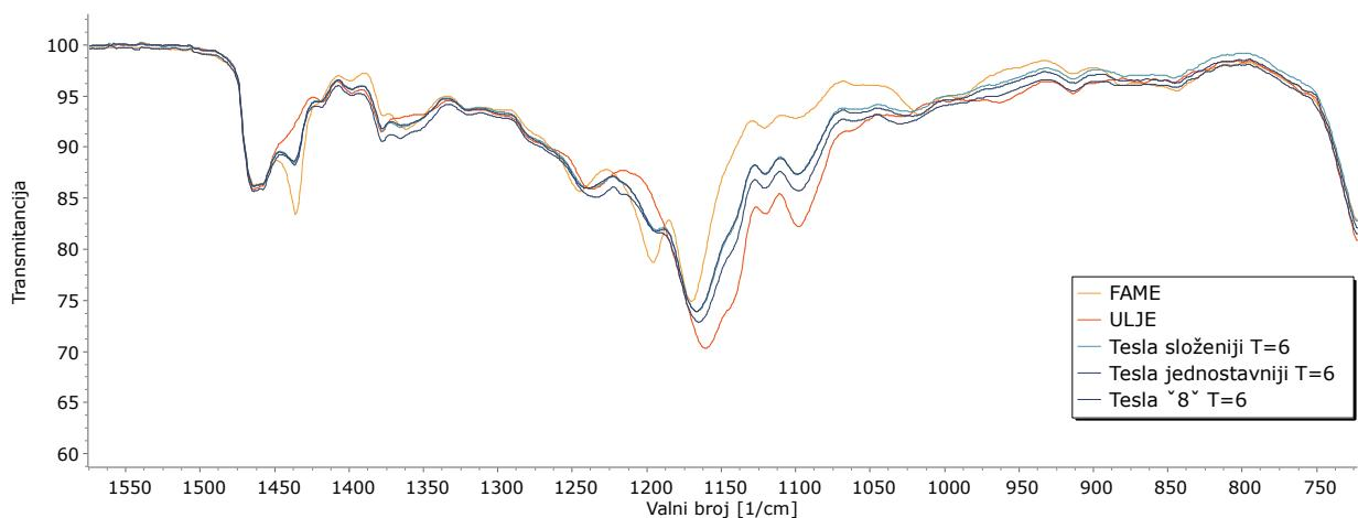
**Slika 20.** FTIR spektri uzorka iz svih reaktora u području karakterističnih vrpcu pri najdužem vremenu zadržavanja na području karakterističnih vrpcu
