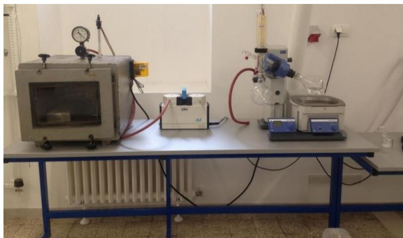
Slika 11. Vakuum sušionik (lijevo) i vakuum isparivač (desno)
