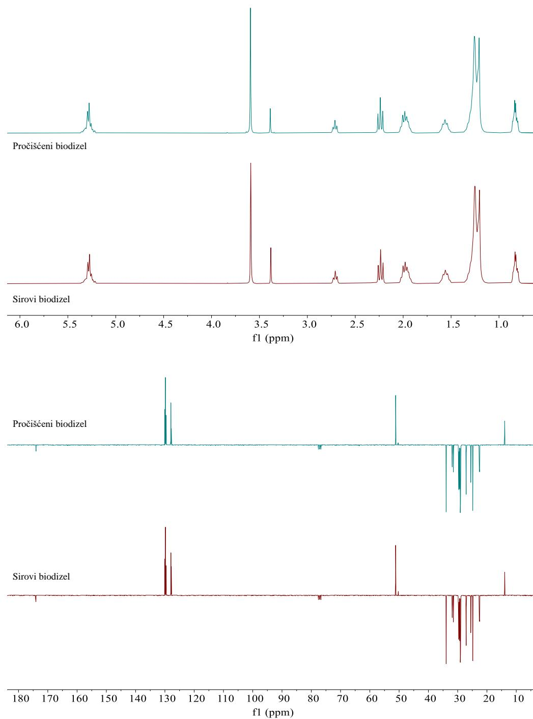
**Slika 28.**  $^1\text{H}$  NMR i  $^{13}\text{C}$  NMR spektri sirovog i pročišćenog biodizela
