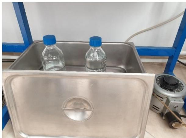
**Slika 8.** Otapanje KOH u metanolu u ultrazvučnoj kupelji
