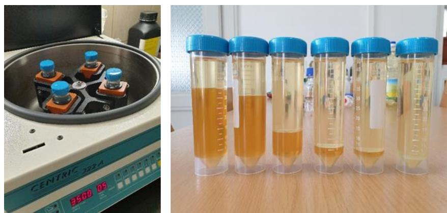
**Slika 10.** Odvajanje biodizela i glicerola nakon centrifugiranja
