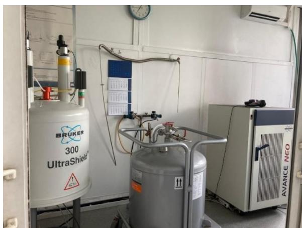
**Slika 18.** NMR spektrometar *Bruker Avance Neo 300*
