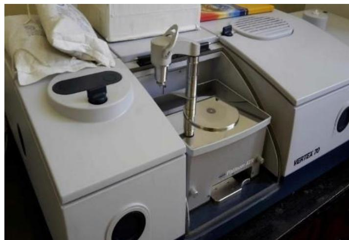
Slika 17. Spektrometar *Bruker Vertex 70*
