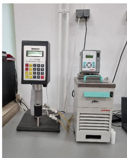
**Slika 14.** Rotacijski viskozimetar *Brookfield DV- III ULTRA*
