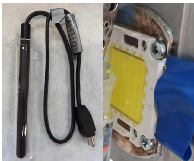
Slika 3.2. UV lampa (lijevo); LED lampa (desno) korištene tijekom fotoelektrokemijskih mjerenja
