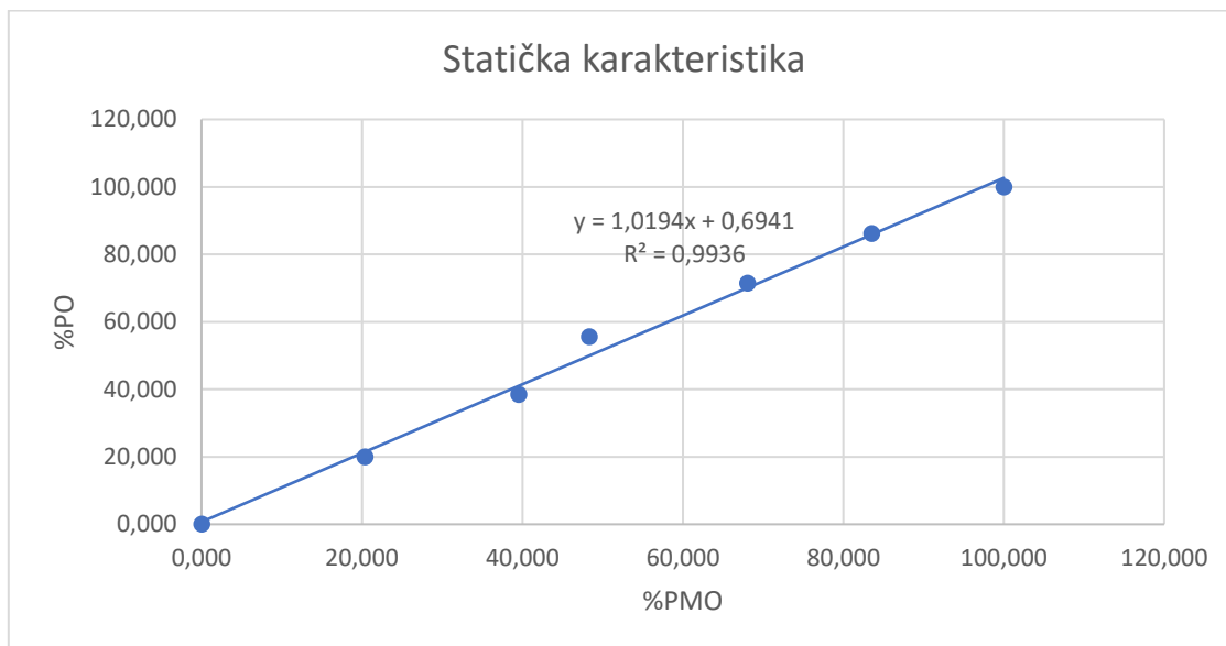
Slika 4-2. Statička karakteristika mjernog pretvornika
