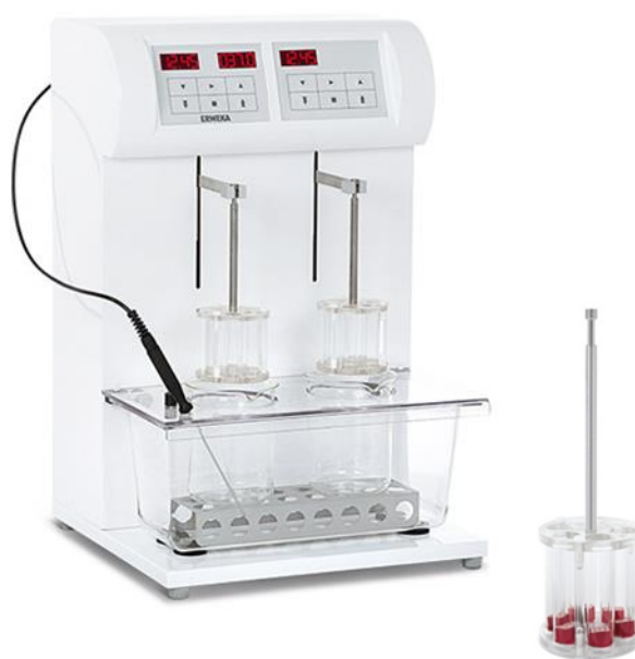
Slika 4.14. Fotografija uređaja za ispitivanje raspadljivosti tableta ZT 322 (Erweka GmbH, Langen, SR Njemačka).
