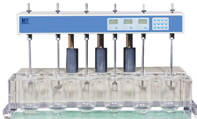
Slika 24. Uređaj za ispitivanje oslobađanja djelatnih tvari (RC-6D, Zhengzhou Nanbei Instrument)
