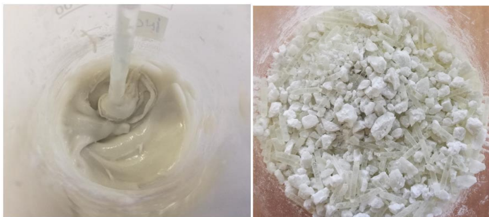
Slika 17. Slika Mješavina rastaljenog PEG-a i DNR-a (lijevo) i Čvrsta disperzija pomiješana s PVA-filamentom (desno)
