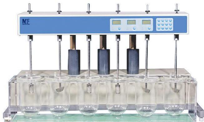
**Slika 24.** Uređaj za ispitivanje oslobođanja djelatnih tvari (RC-6D, Zhengzhou Nanbei Instrument)
