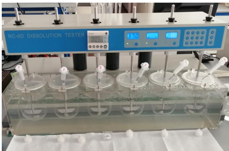
Slika 36. Ispitivanje oslobađanja dronedarona in vitro
