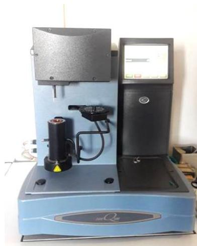
*Slika 18.* Termogravimetar Q500 tvrtke TA Instruments
