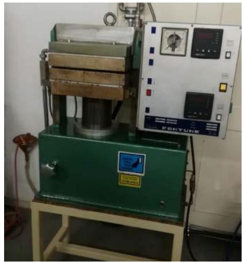
*Slika 17.* Hidrauliča preša Fontune, Holland
