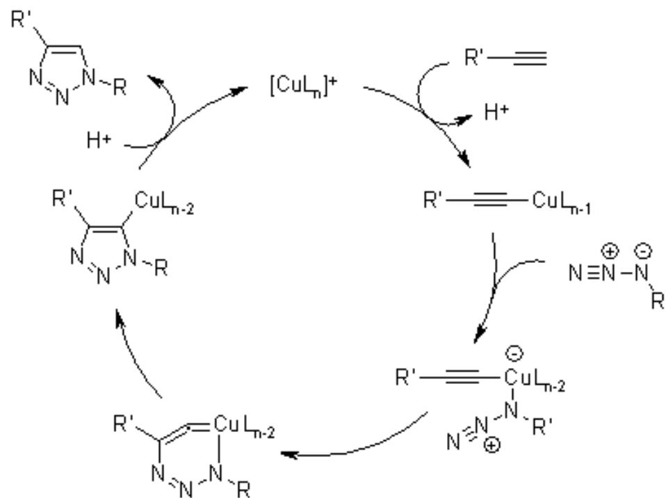
Slika 21. Mehanizam CuAAC reakcije
