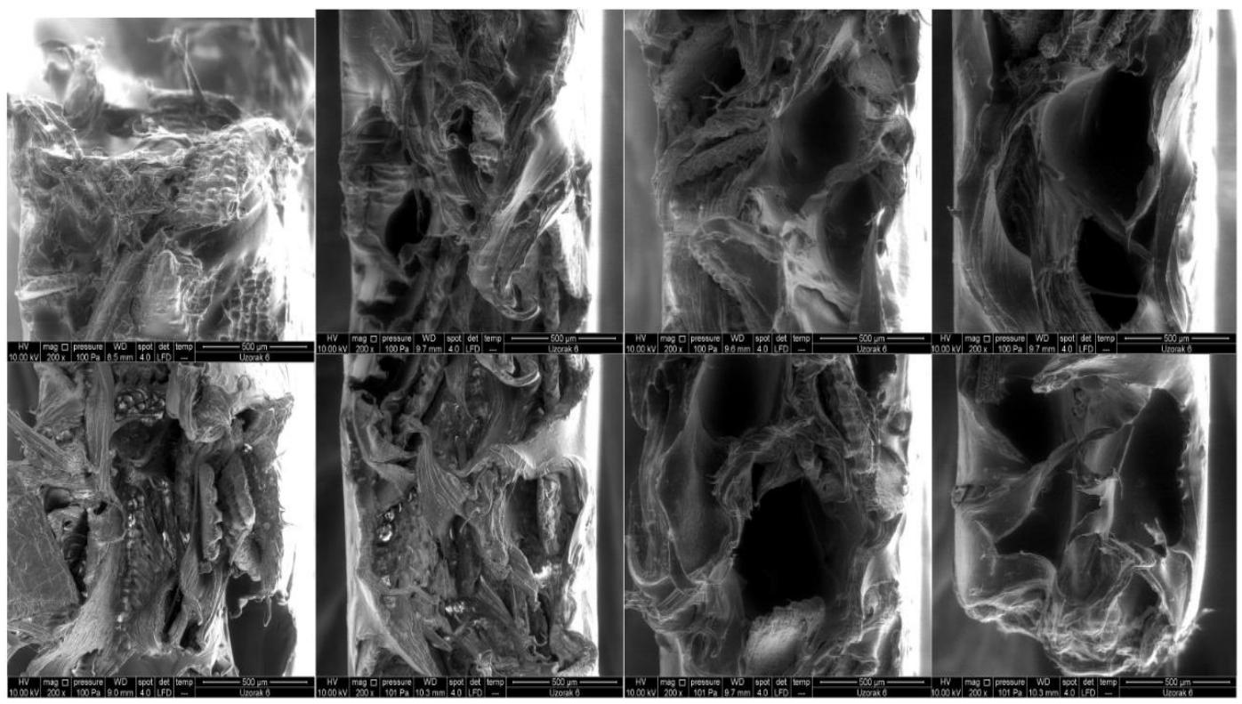
Slika 41. Razni SEM mikrografije LLDPE/RLJ 70/30 biokompozita bez dodatka m TiO<sub>2</sub>: uvećanje 200 x.
