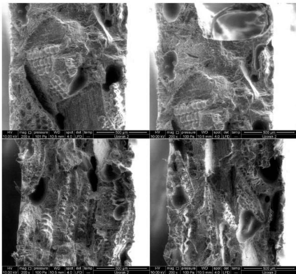
Slika 32. SEM mikrografije LLDPE/RLJ 50/50 biokompozita s dodatkom m TiO<sub>2</sub>: uvećanje 200x.
