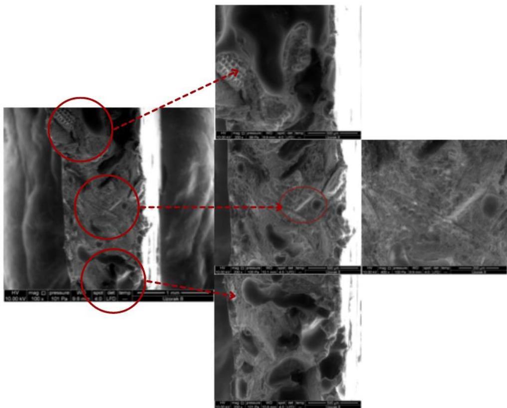
Slika 30. SEM mikrografije LLDPE/RLJ 50/50 biokompozita bez dodatka m TiO<sub>2</sub>: uvećanje 500x i 200x.
