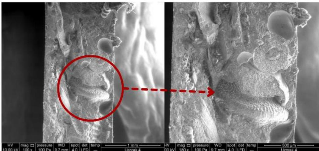
Slika 39. SEM mikrografije LLDPE/RLJ 60/40 biokompozita s dodatkom m TiO<sub>2</sub>: uvećanje 100x.
