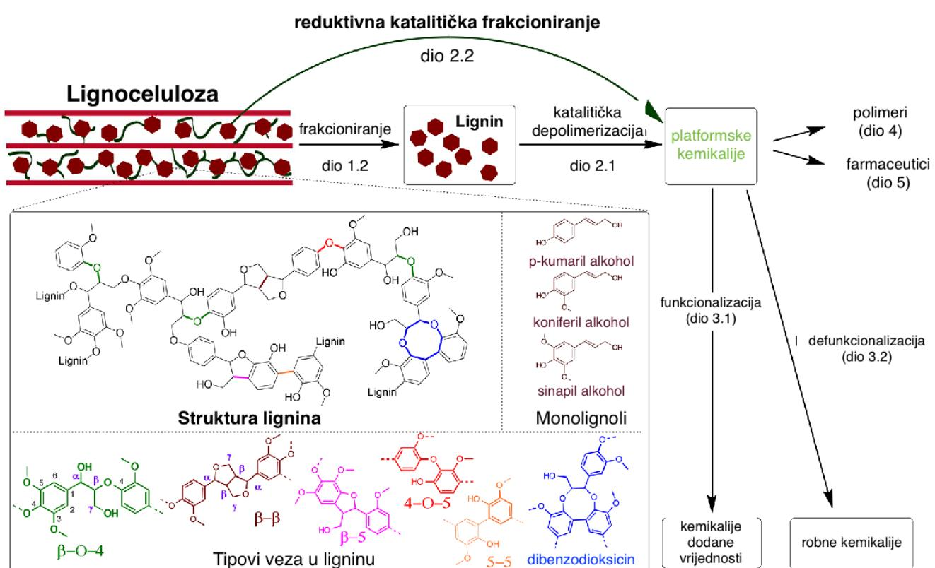
Slika 13. Prikaz strukture lignina i najčešćih veza u ligninu. (lijevo) Reprezentativna struktura lignina koja prikazuje tipične monomer jedinice lignina i spojeve na koje nailazimo. (desno) Opći kemijski put za depolimerizaciju lignina i primjenu platformskih kemikalija izvedenih iz lignina. [27]
