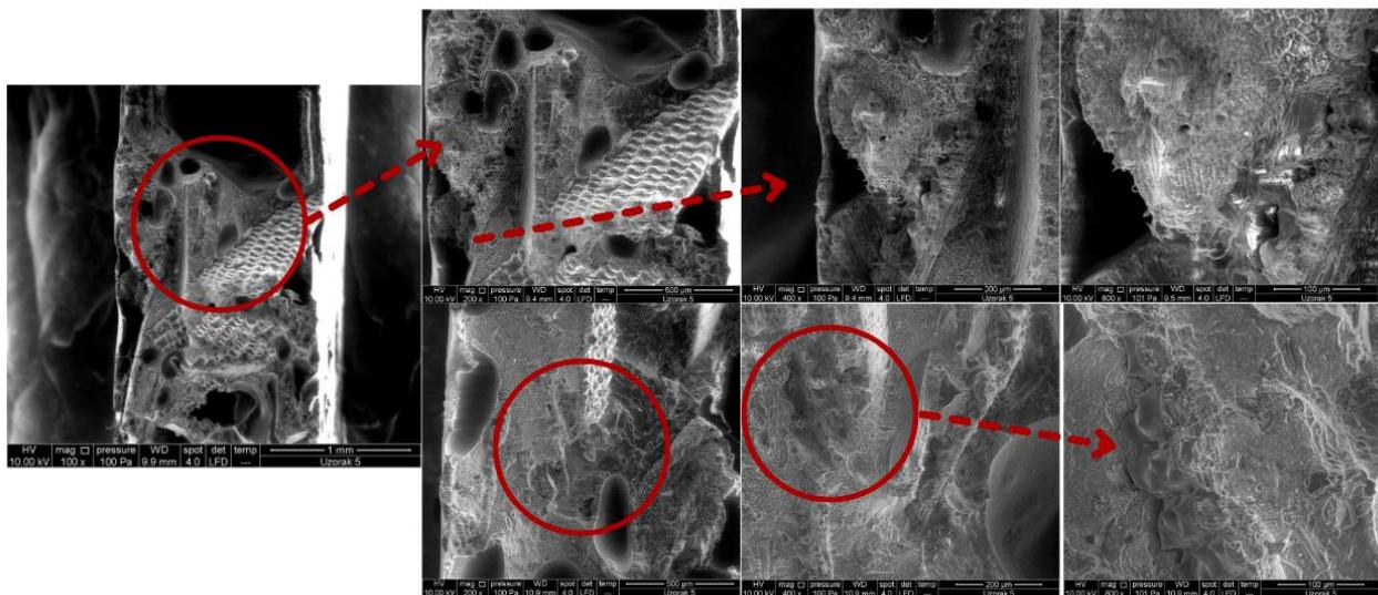
Slika 45. SEM mikrografije LLDPE/RLJ 70/30 biokompozita s dodatkom m TiO<sub>2</sub>: uvećanje 100x, 200x i 400x.
