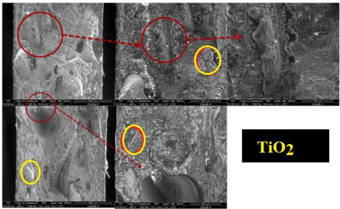
Slika 40. SEM mikrografije LLDPE/RLJ 60/40 biokompozita s dodatkom m TiO<sub>2</sub> na različitim lokacijama: uvećanje 100x, 400x i 800x.
