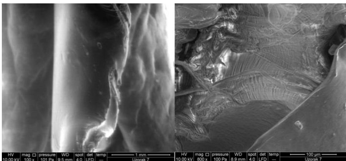
Slika 52. SEM mikrografija vanjske strane stijenke LLDPE/RLJ 90/10 biokompozita bez dodatka m TiO<sub>2</sub>: uvećanje 100 i 800x.
