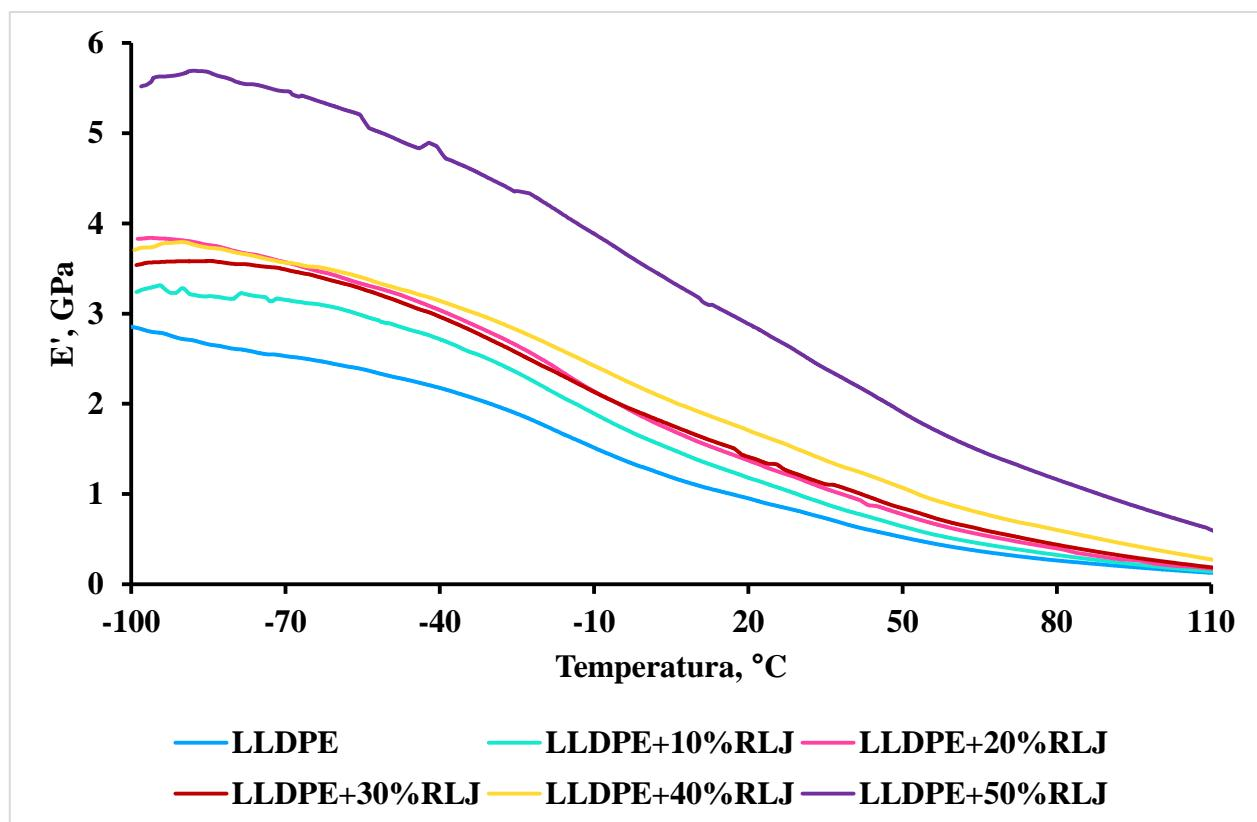
Slika 58. DMA krivulje modula pohrane  $E'$  čistog LLDPE-a i LLDPE/RLJ biokompozita s različitim udjelom RLJ.
