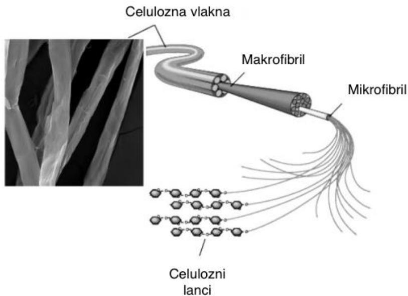
Slika 10. Prikaz gomilanje celuloznih lanaca u celulozna vlakna.
