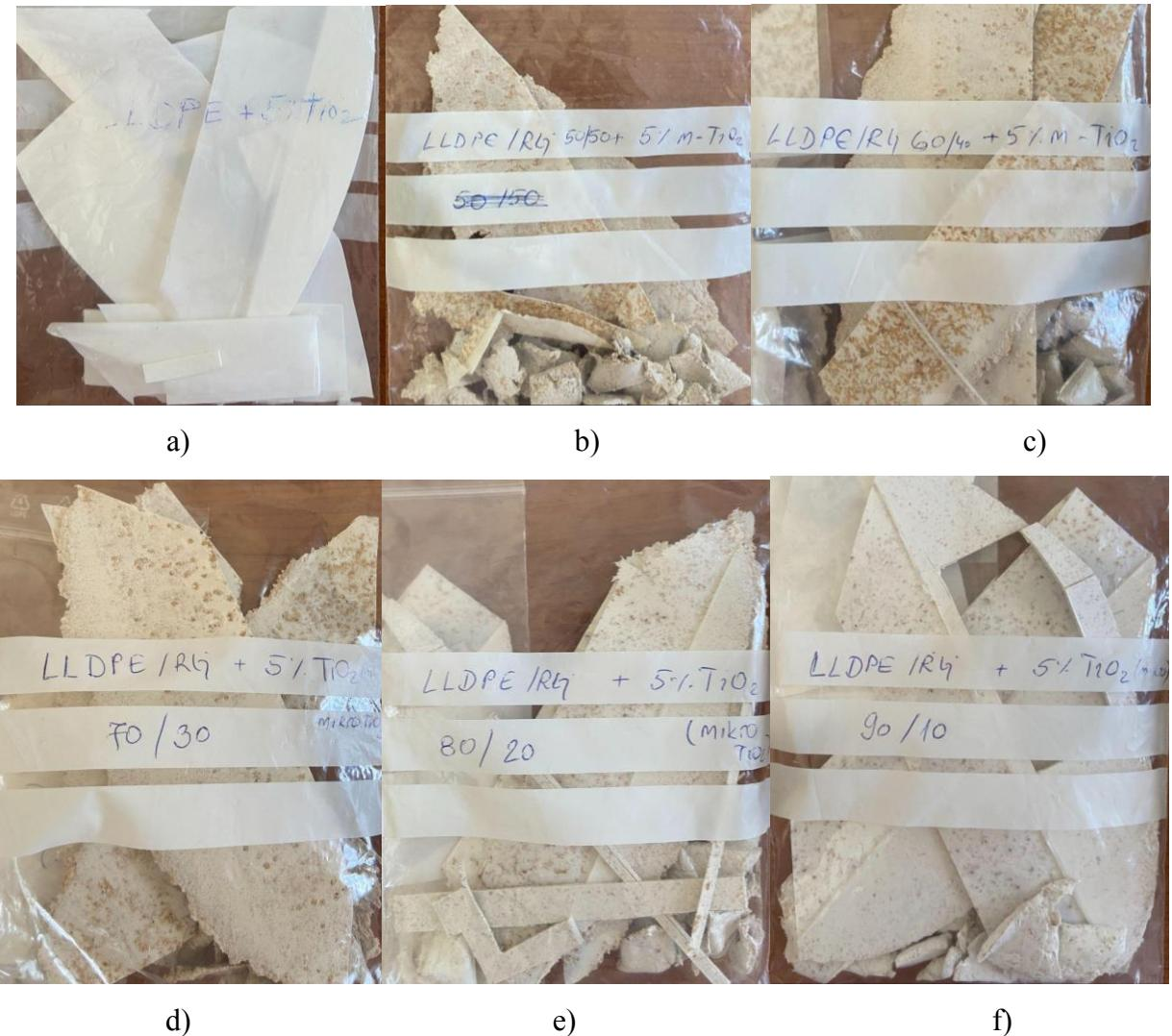
Slika 24. Uzorci LLDPE/RLJ s dodatkom 5% mTiO<sub>2</sub>, s različitim udjelom RLJ: a) čisti LLDPE s dodatkom TiO<sub>2</sub>, b) LLDPE/RLJ 50/50, c) LLDPE/RLJ 60/40, d) LLDPE/RLJ 70/50, e) LLDPE/RLJ 80/20, f) LLDPE/RLJ 90/10.
