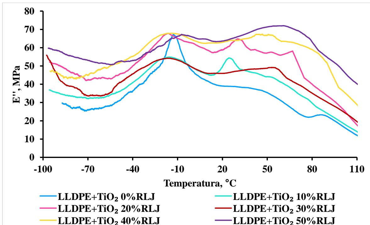
Slika 61. DMA krivulje modula gubitka  $E''$  čistog LLDPE-a i LLDPE/RLJ/mTiO<sub>2</sub> biokompozita s različitim udjelom RLJ.
