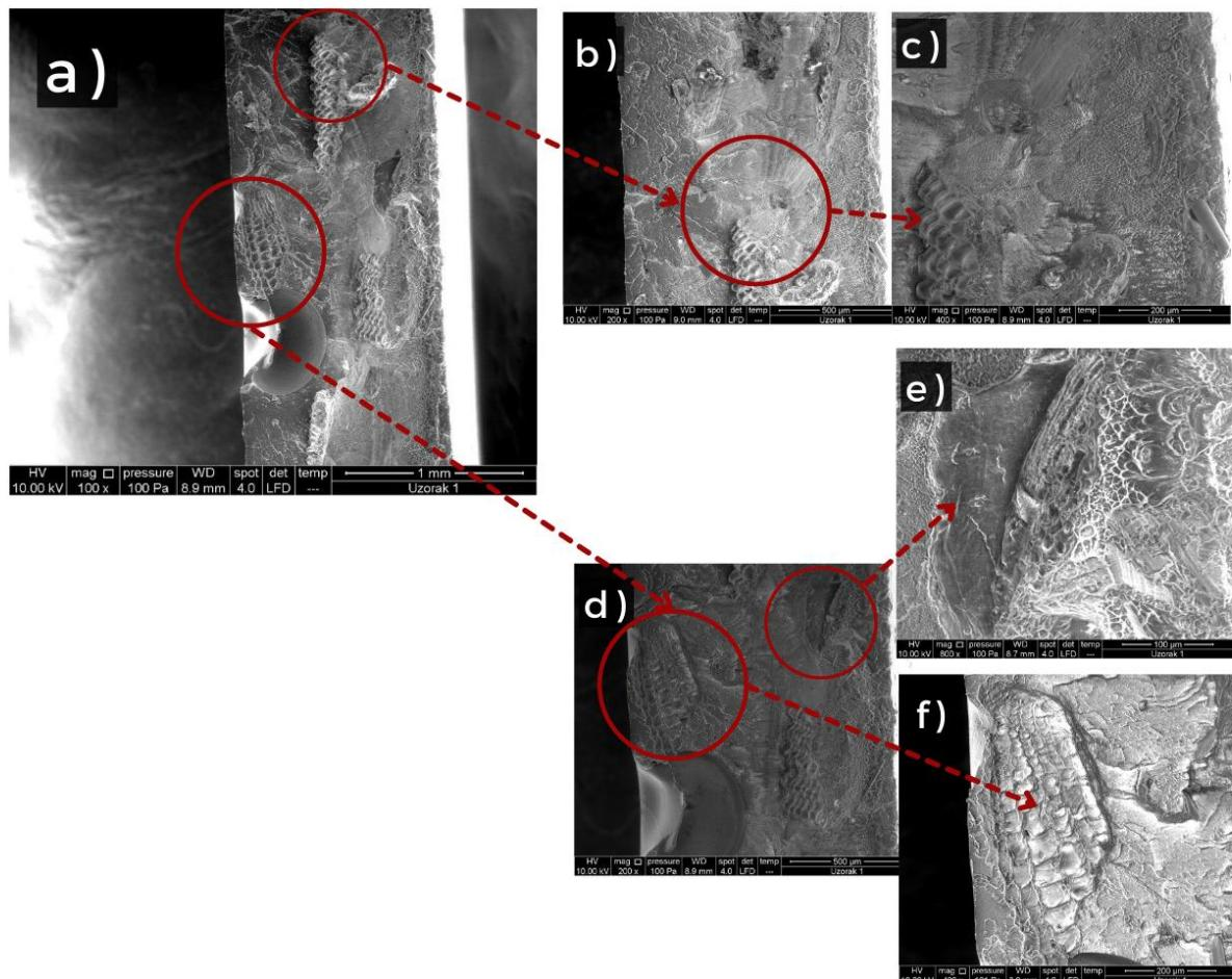
Slika 49. SEM mikrografije LLDPE/RLJ 80/20 biokompozita s dodatkom m TiO<sub>2</sub>: a) uvećanje 100x, b) i d) uvećanje 200x te c), e) i f) uvećanje 400x koji se fokusiraju na segmente na kojima je jasno uočljiv fragment RLJ
