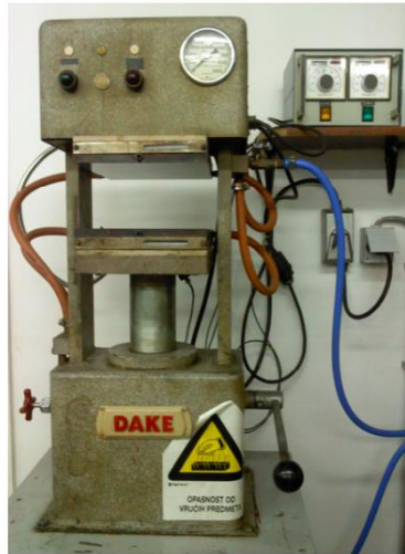
Slika 21. Preša Dake model 44-226. [52]
