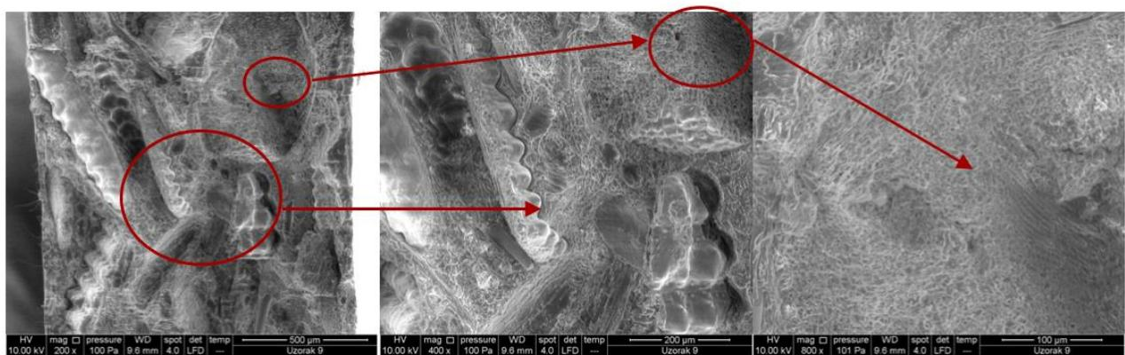
Slika 47. SEM mikrografija LLDPE/RLJ 80/20 biokompozita bez dodatka m TiO<sub>2</sub>: uvećanje 200x, 400x i 800x - detalj LLDPE-a.
