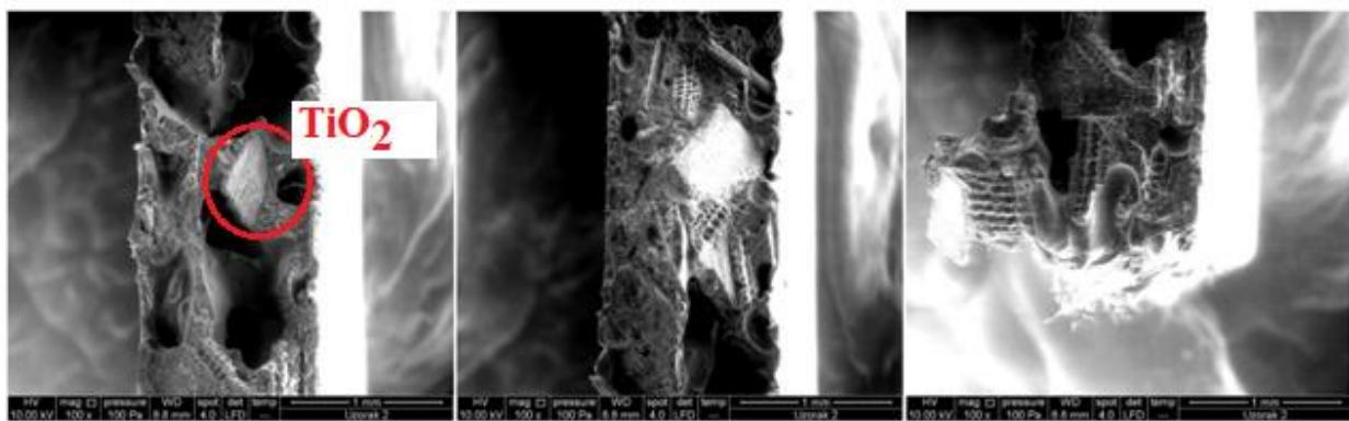
Slika 31. SEM mikrografije LLDPE/RLJ 50/50 biokompozita s dodatkom m TiO<sub>2</sub>: uvećanje 100x.
