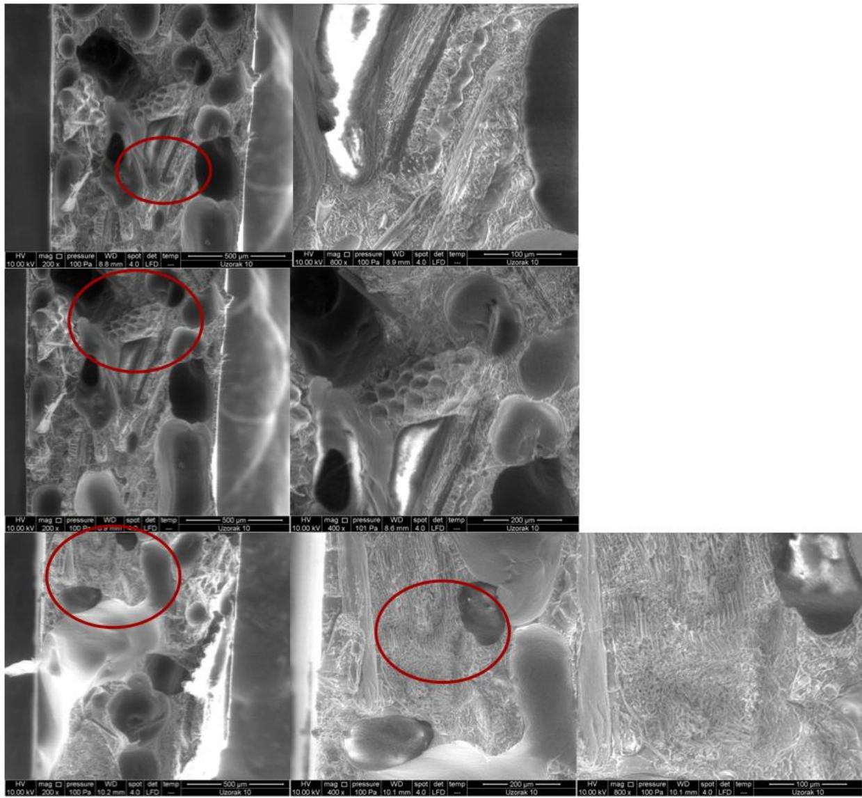
Slika 37. SEM mikrografije LLDPE/RLJ 60/40 biokompozita bez dodatka m TiO<sub>2</sub> na različitim lokacijama: uvećanje 200x, 400x i 800x.
