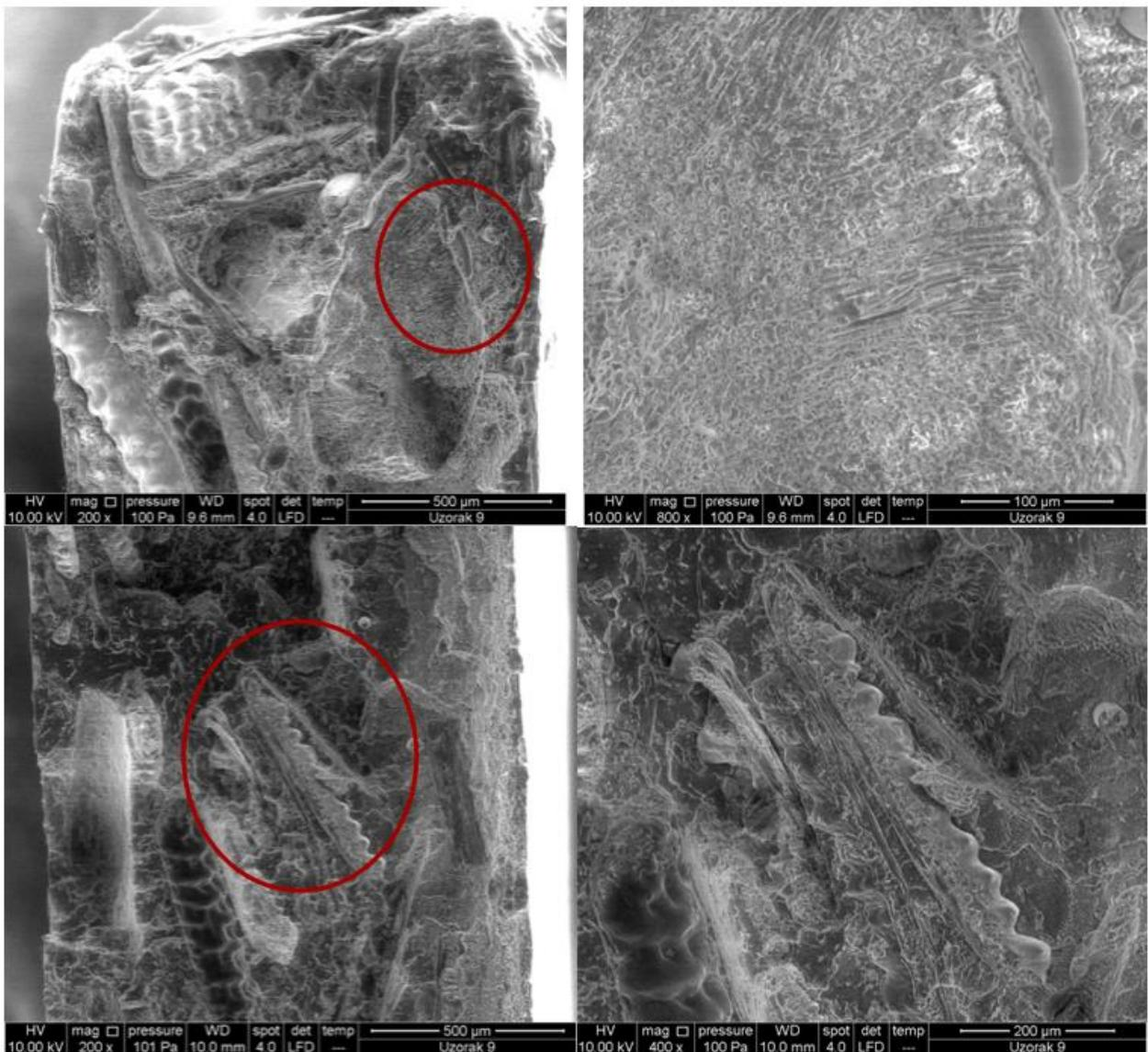
Slika 48. SEM mikrografije LLDPE/RLJ 80/20 biokompozita bez dodatka m TiO<sub>2</sub>: uvećanje 200, 800 i 400 - prikaz detalja lјuskice.
