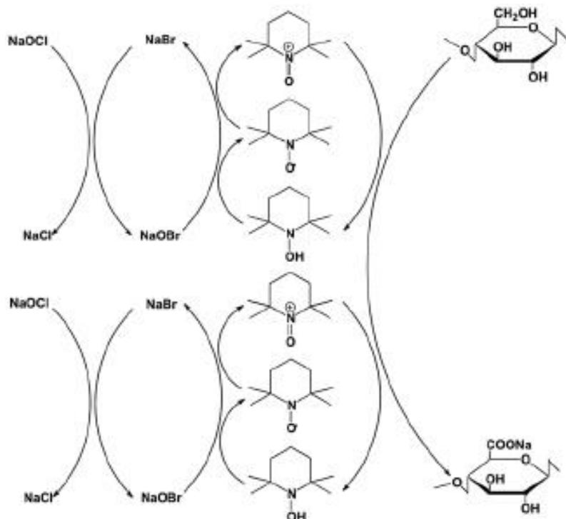
Slika 11. Shema TEMPO-posredovanog mehanizma oksidacije hidroksimetilnih skupina celuloze. [22]
