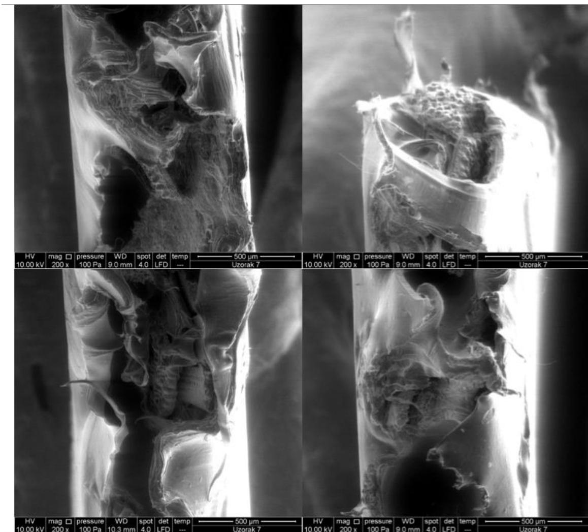
Slika 51. SEM mikrografije LLDPE/RLJ 90/10 biokompozita bez dodatka m TiO<sub>2</sub>: uvećanje 200x.
