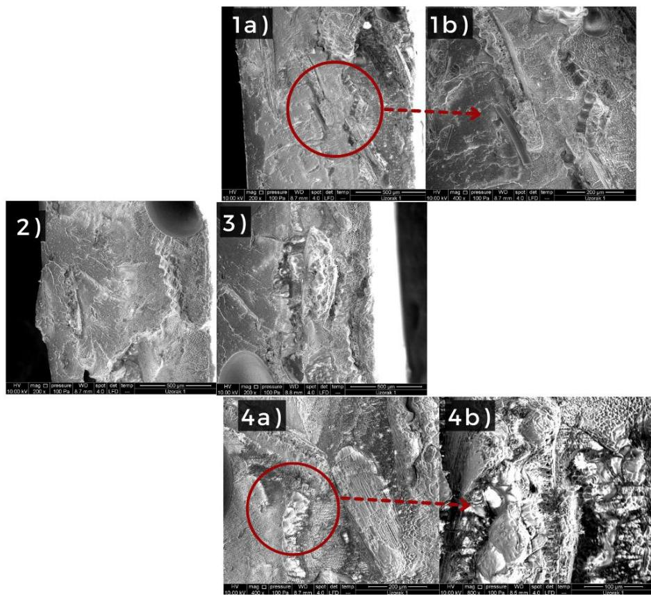
Slika 50. SEM mikrografije LLDPE/RLJ 80/20 biokompozita s dodatkom m  $\text{TiO}_2$ : uvećanje 200x i 400x (1a), 1b)), 200x (2 i 3) te 400x i 800x (4a) i 4b)) - prikaz detalja ljuskice.
