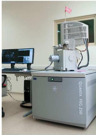
Slika 26. pretražni elektronski mikroskop FEI QUANTA 250 FEG.
