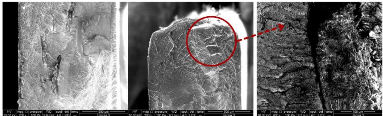
Slika 56. SEM mikrografije LLDPE/RLJ 90/10 biokompozita s dodatkom mTiO<sub>2</sub>: uvećanje 200x i 800x - detalj pukotine u matrici LLDPE-a.
