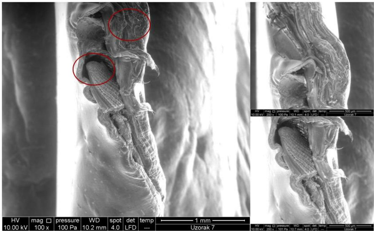
Slika 54. SEM mikrografije LLDPE/RLJ 90/10 biokompozita bez dodatka mTiO<sub>2</sub>: uvećanje 100x i 200x - prikaz vlakana RLJ prilikom otvaranja stijenke biokompozita.
