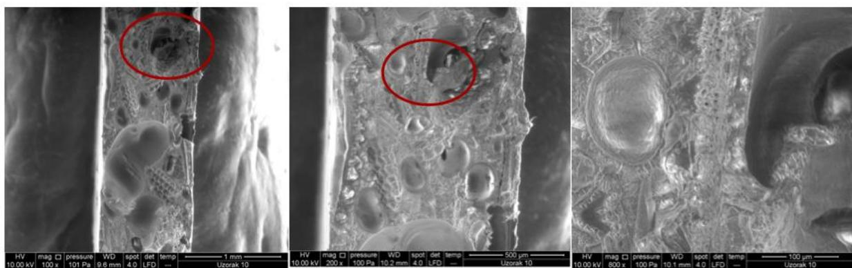
Slika 36. SEM mikrograf uzorka LLDPE/RLJ 60/40 bez dodatka m TiO<sub>2</sub>: uvećanje 100x, 200x i 800x.
