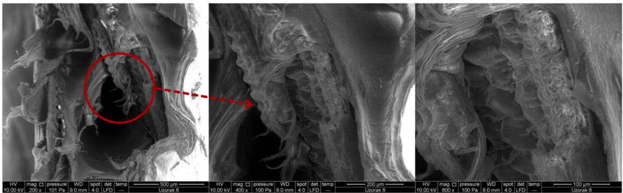
Slika 42. Uvećani prikaz ljuskice riže kod šuplje strukture uzorka.
