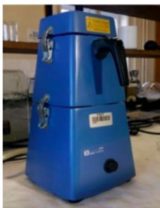
Slika 19. Mikser IKA-WERKE M20.
