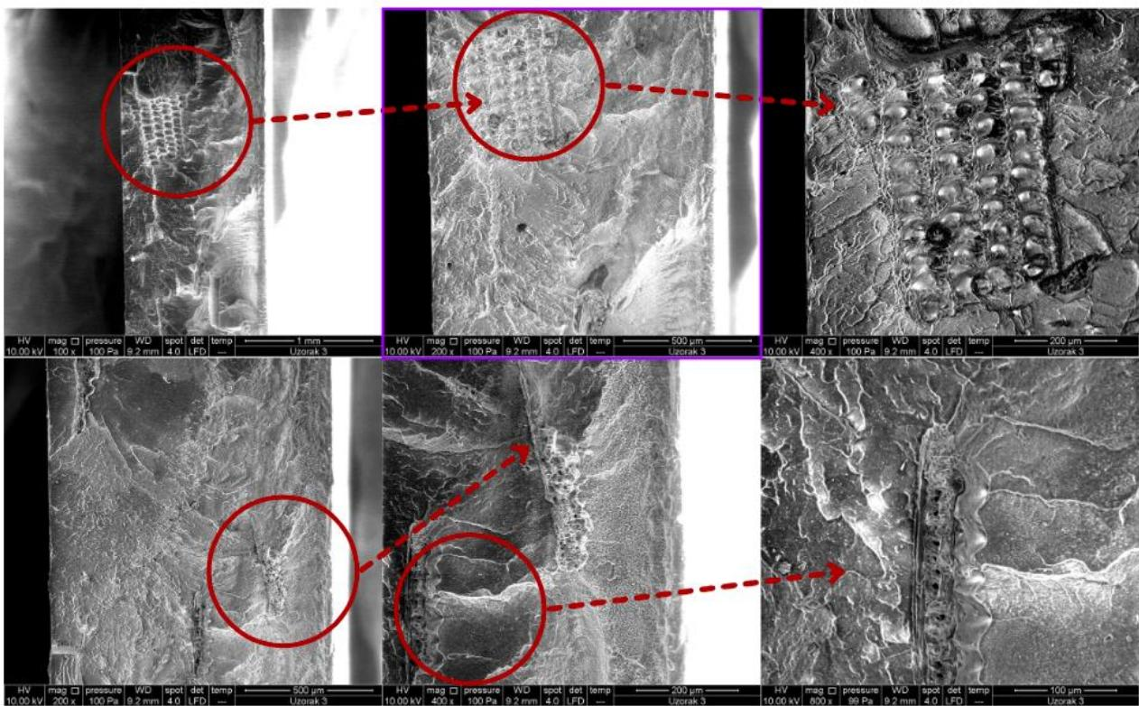
Slika 55. SEM mikrografije LLDPE/RLJ 90/10 biokompozita s dodatkom mTiO<sub>2</sub>: uvećanje 100x, 200x, 400x i 800x - detalji rižine ljuskice.
