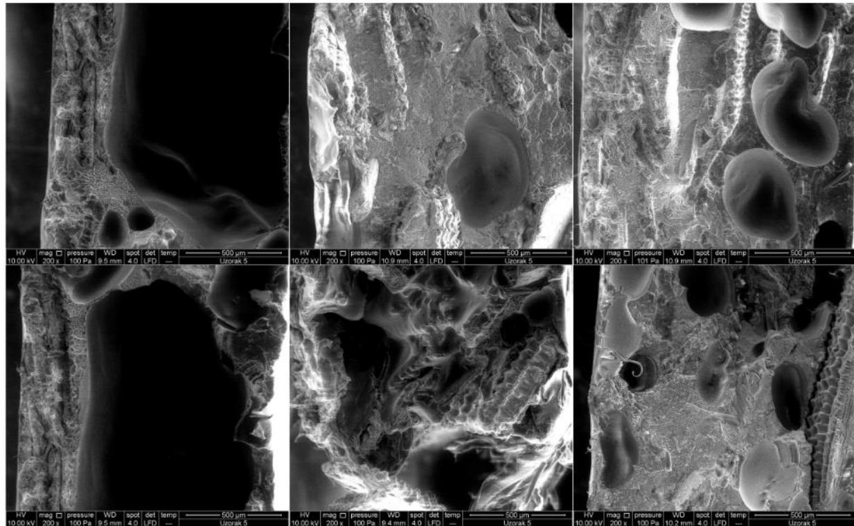
Slika 44. SEM mikrografije LLDPE/RLJ 70/30 biokompozita s dodatkom m TiO<sub>2</sub>: uvećanje 200x.
