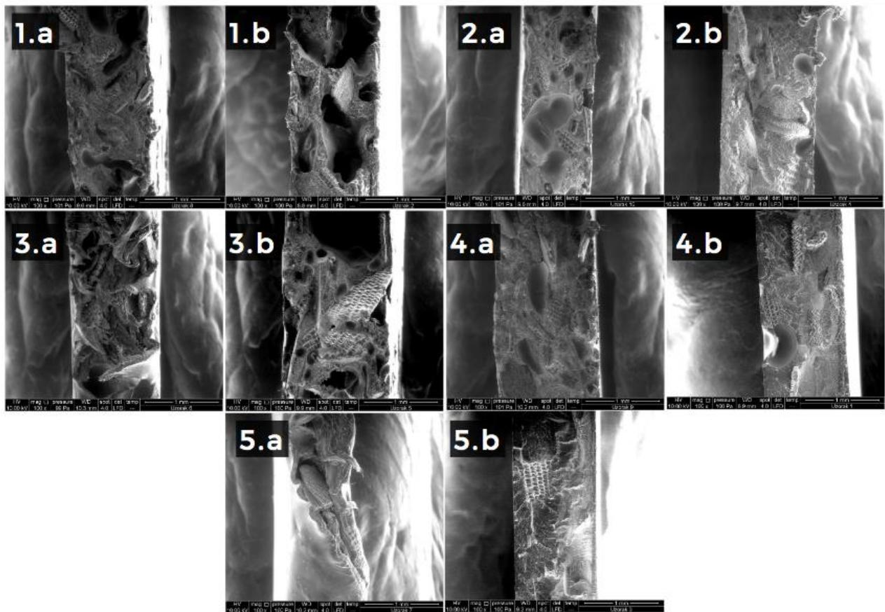
Slika 57. SEM mikrografije svih biokompozita bez i s dodatkom mTiO<sub>2</sub>, pri uvećanju od 100x
