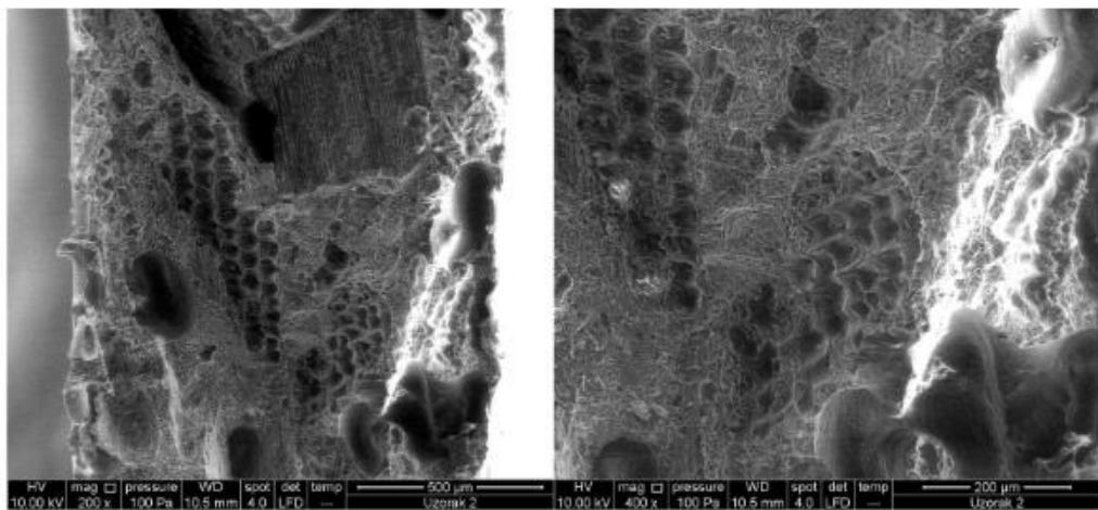
Slika 33. SEM mikrografije LLDPE/RLJ 50/50 biokompozita s dodatkom m TiO<sub>2</sub>: uvećanje 200x i 400x.
