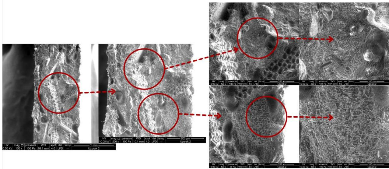
Slika 34. SEM mikrografije LLDPE/RLJ 50/50 biokompozita s dodatkom m TiO<sub>2</sub>: uvećanje 100x, 200x i 500x.
