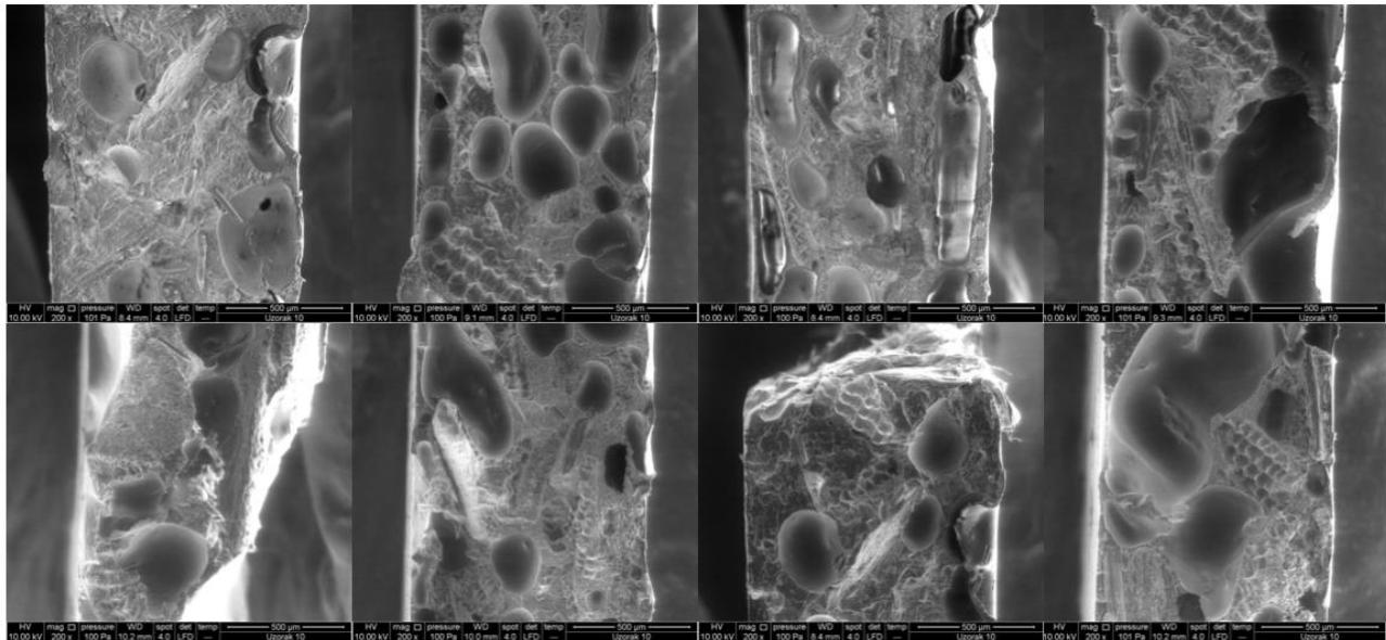
Slika 35. SEM mikrografije LLDPE/RLJ 60/40 biokompozita bez dodatka m TiO<sub>2</sub>: uvećanje 200x.
