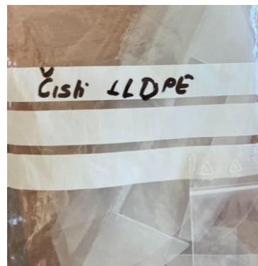
Slika 22.Uzorak čistog LLDPE-a.
