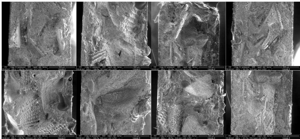
Slika 38. SEM mikrografije LLDPE/RLJ 60/40 biokompozita s dodatkom m TiO<sub>2</sub>: uvećanje 200x.
