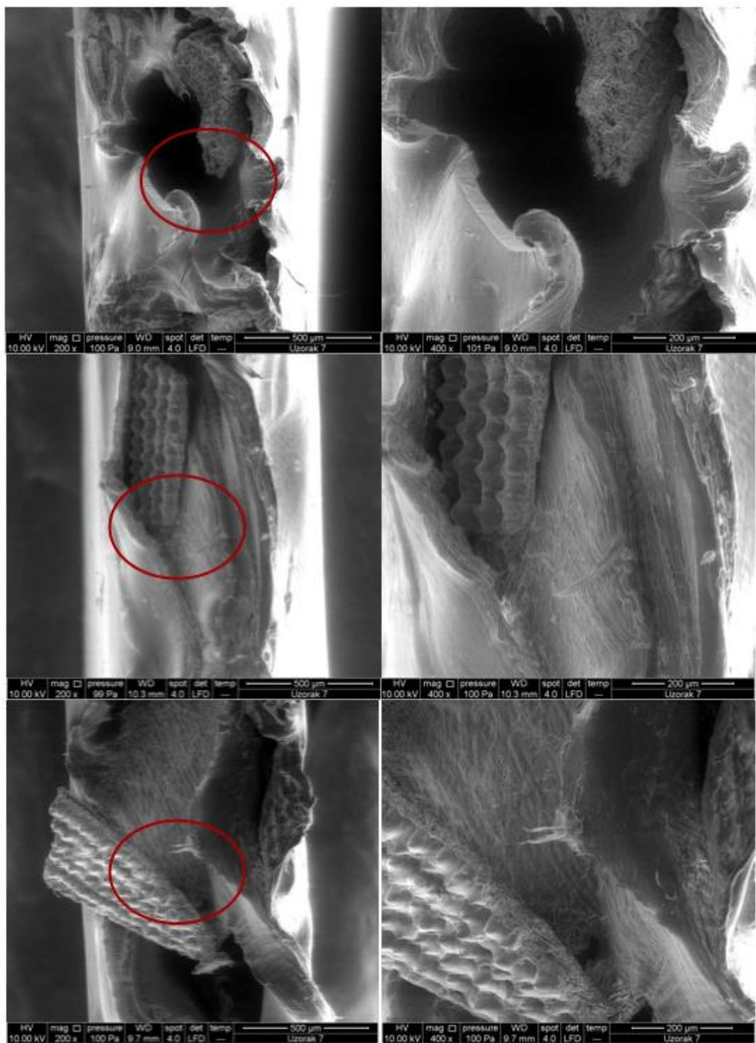
Slika 53. SEM mikrografije LLDPE/RLJ 90/10 biokompozita bez dodatka mTiO<sub>2</sub>: uvećanje 200x i 400x - prikaz oblaganja unutarnje strane stijenke vlakna RLJ.
