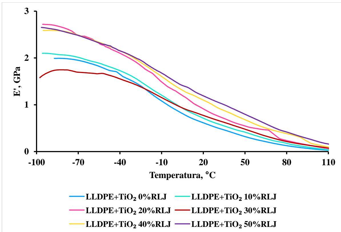
Slika 60. DMA krivulje modula pohrane  $E'$  čistog LLDPE-a i LLDPE/RLJ/mTiO<sub>2</sub> biokompozita s različitim udjelom RLJ.
