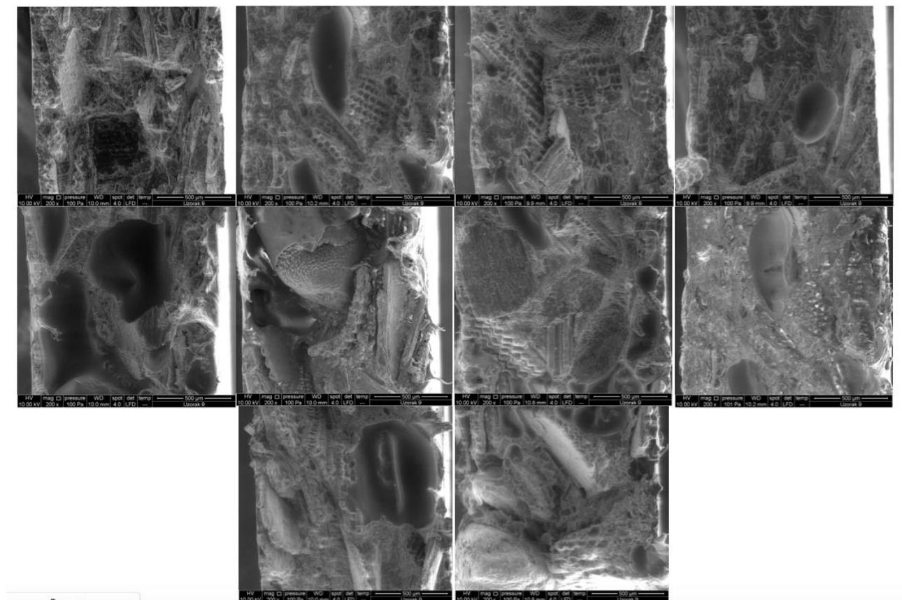
Slika 46. SEM mikrografije LLDPE/RLJ 80/20 biokompozita bez dodatka m TiO<sub>2</sub>: uvećanje 200x.
