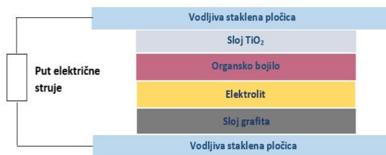
Slika 4. Shematski prikaz Grätzelove solarne ćelije
