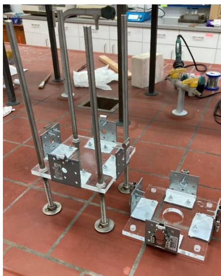
Slika 20. Kućište elektrokemijske ćelije
