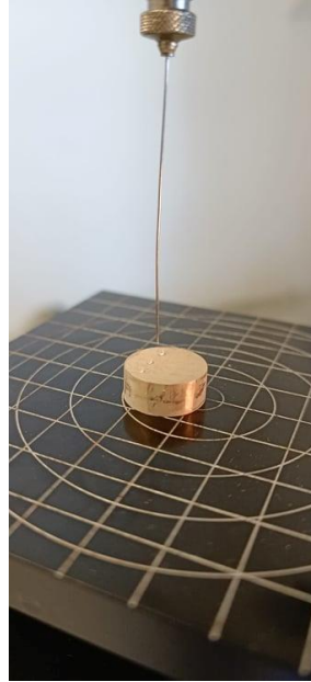
Slika 41. Prikaz snimanja kontaktnog kuta
