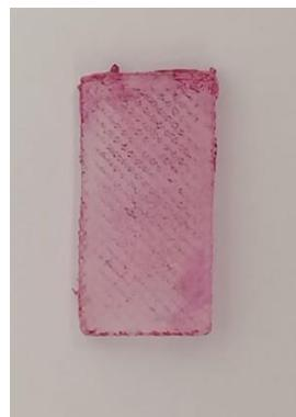
Slika 32. Pločica nakon stajanja u otopini pH 2,1
