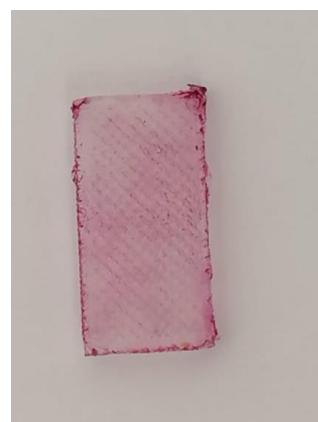
Slika 39. Pločica nakon stajanja u otopini pH 9,1
