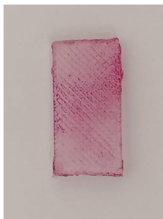
Slika 36. Pločica nakon stajanja u otopini pH 6,1
