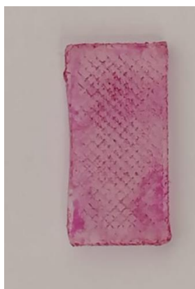
Slika 38. Pločica nakon stajanja u otopini pH 7,9
