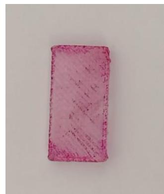
Slika 34. Pločica nakon stajanja u otopini pH 4,1
