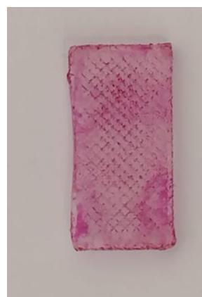
Slika 38. Pločica nakon stajanja u otopini pH 7,9
