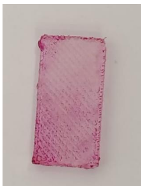
Slika 33. Pločica nakon stajanja u otopini pH 3,1
