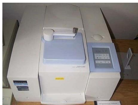
Slika 30. Uredaj PerkinElmer Spectrum One
