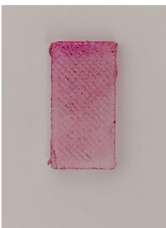
Slika 35. Pločica nakon stajanja u otopini pH 5,0
