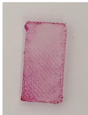
Slika 33. Pločica nakon stajanja u otopini pH 3,1
