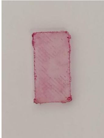
Slika 40. Pločica nakon stajanja u otopini pH 9,9
