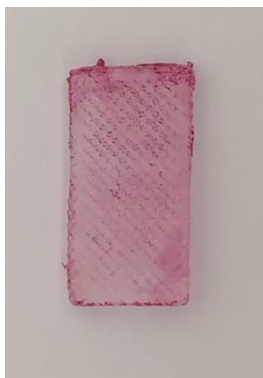
Slika 32. Pločica nakon stajanja u otopini pH 2,1
