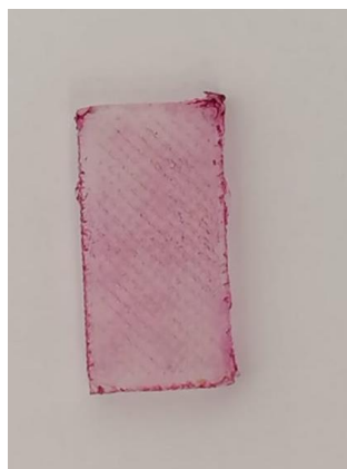
Slika 38. Pločica nakon stajanja u otopini pH 7,9
