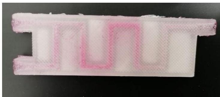
Slika 27. Rezultat nanošenja filmova unutar milireaktora s kružnim kanalima
