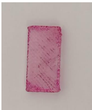
Slika 34. Pločica nakon stajanja u otopini pH 4,1
