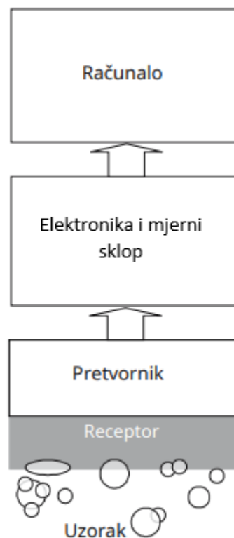
Slika 7. Shematski prikaz kemijskog senzorskog sustava 14
