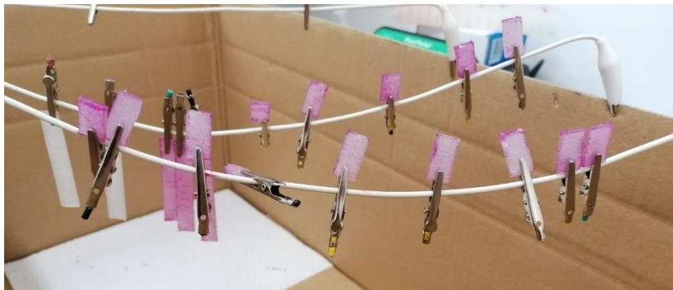
Slika 26. Sušenje pločica nakon nanošenja smjese senzorskih filmova.
