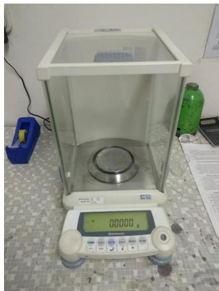
Slika 3.1. Analitička vaga *AUW120* (*Shimadzu*)
