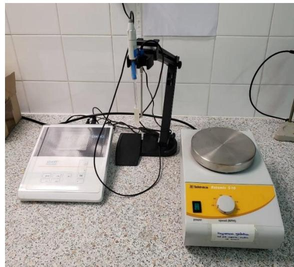
Slika 3.5. pH elektroda BlueLine 16 SI Analytics i magnetska mješalica Rotamix S-10
