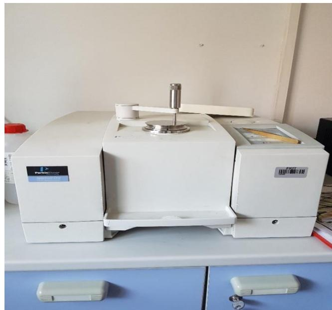
Slika 9 : Perkin Elmer Spectrum One, FTIR spektrometar (izvor: vlastita fotografija)
