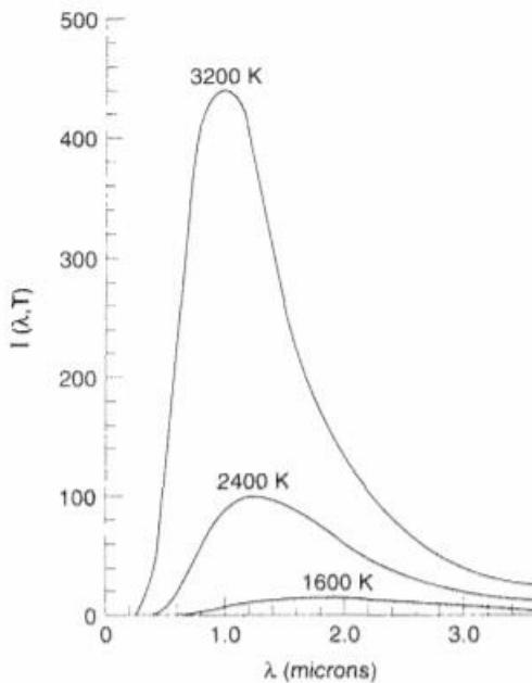
**Slika 8. Spektralna raspodjela  $I(\lambda, T)$  zračenja emitiranog s užarenog tijela. Kako temperatura raste, ukupni tok raste, a vrh(maksimum) spektralne raspodjеле pomici se prema kraćim valnim duljinama.<sup>[11]</sup>**
