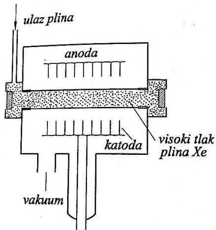
Slika 25. Shematski prikaz ekscimerskog lasera s plinom Xe<sup>[10]</sup>
