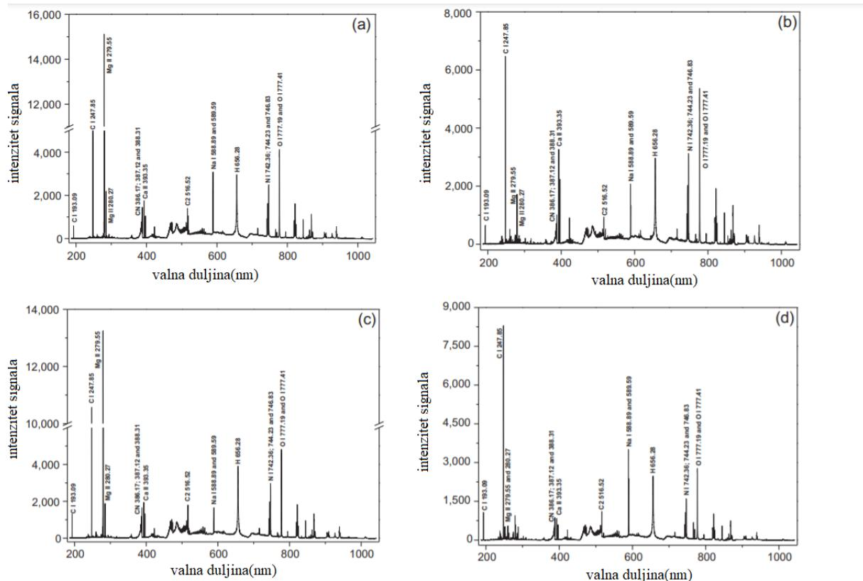
**Slika 42. Emisijski spektar za a) uzorak 100% PC, b) uzorak 100% ABS, c) uzorak 50/50 % PC/ABS te d) Uzorak koji nije bio pripravljen niti miješan<sup>[5]</sup>**
