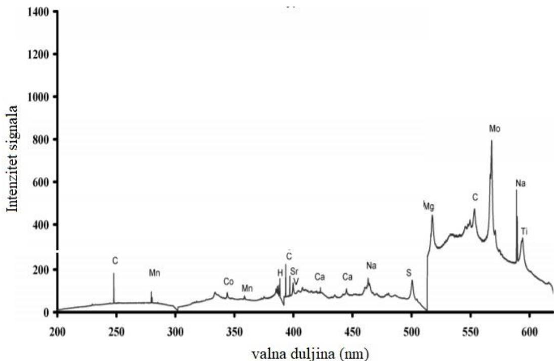
Slika 39. Spektar laserom inducirane probajne spektroskopije PP-a<sup>[4]</sup>
