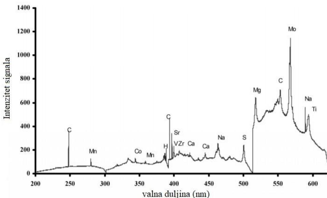
Slika 36. Spektar laserom inducirane probojne spektroskopije HDPE-a<sup>[4]</sup>
