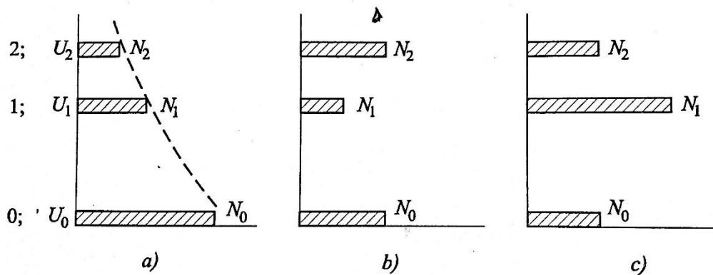
**Slika 11. Osnovni princip inverzije naseljenosti<sup>[10]</sup>**
