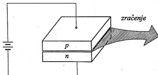
**Slika 23. Crtež p-n diodnog lasera, p-n spoj nacrtan je uvećano.<sup>[10]</sup>**
