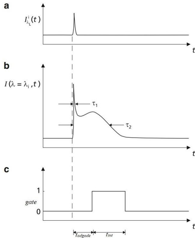
**Slika 32. Shematski prikaz vremenske ovisnosti:** a) laserskog impulsa, b) emisije plazme na valnoj duljini  $\lambda_i$   $I(\lambda=\lambda_i, t)$  intenzitet emisije za valnu duljinu  $i$ ;  $\tau_1, \tau_2$  vremena polovice maksimuma. c) gate signal koji određuje poziciju i duljinu vremena integracije. [17]
