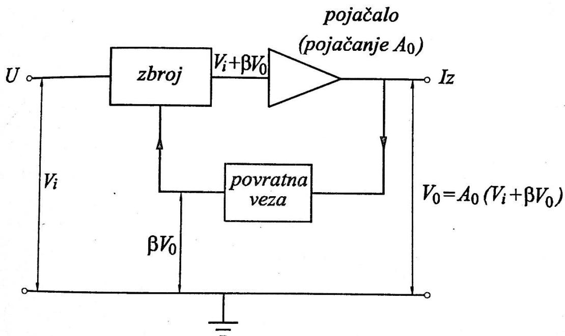
Slika 5. Sklop jednostavnog pojačala i pozitivne povratne veze<sup>[10]</sup>
