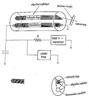
Slika 16. Shematski prikaz rubinskog lasera<sup>[10]</sup>
