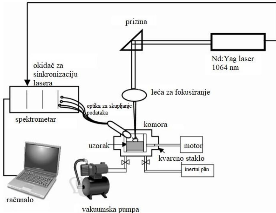
**Slika 35. Shematski dijagram korištene aparature u eksperimentu<sup>[4]</sup>**
