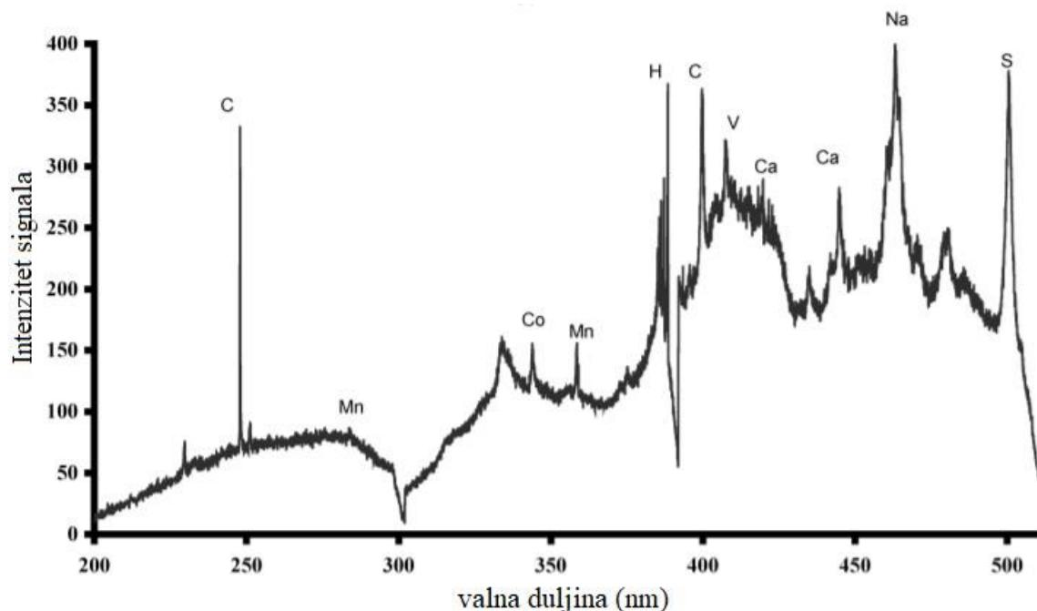
Slika 41. Spektar laserom inducirane probajne spektroskopije PVC-a<sup>[4]</sup>
