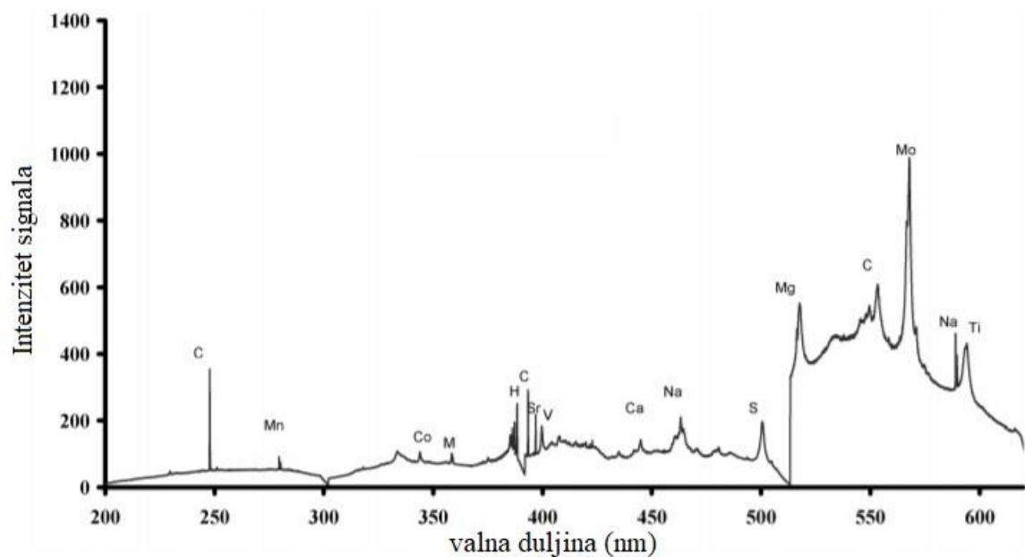
Slika 40. Spektar laserom inducirane probajne spektroskopije PS-a<sup>[4]</sup>
