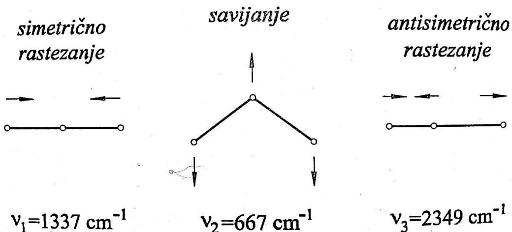
Slika 19. Tri vibracijska moda CO<sub>2</sub> molekule<sup>[10]</sup>
