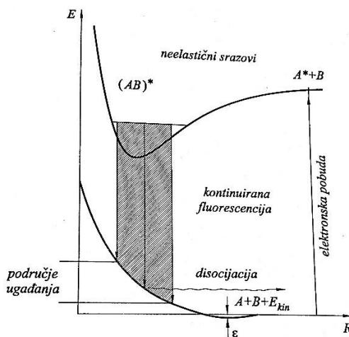
Slika 24. Potencijalne energije ekscimerske molekule u ovisnosti o udaljenosti atoma<sup>[10]</sup>
