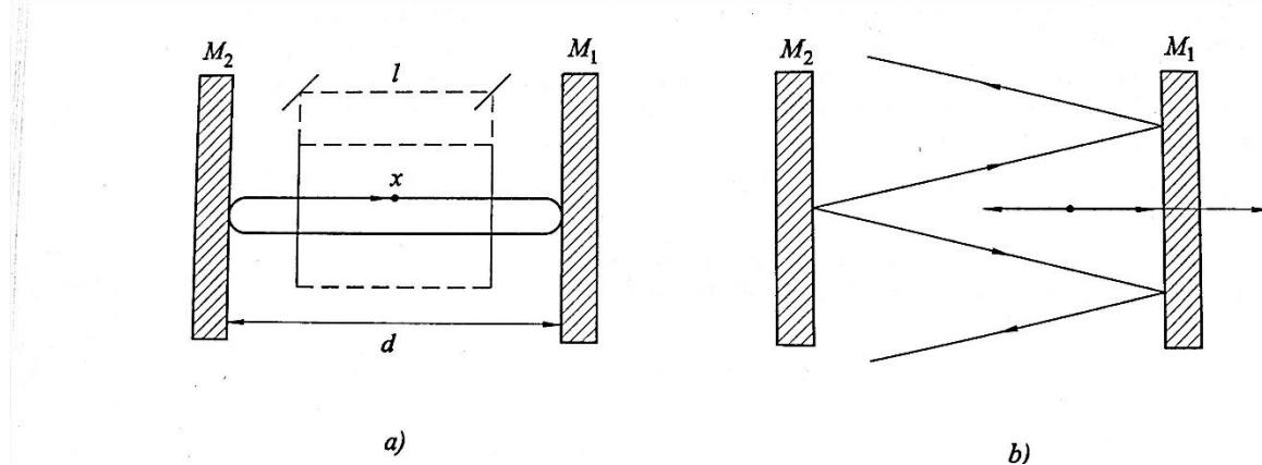
**Slika 13. a) Model laserske šupljine. Svjetlosni val je emitiran s mesta  $x$  i nakon refleksije na zrcalima  $M_1$  i  $M_2$  udaljenih  $d$  vraća se na mjesto  $x$  pojačan duž staze i sredstvom u laserskoj cijevi**
