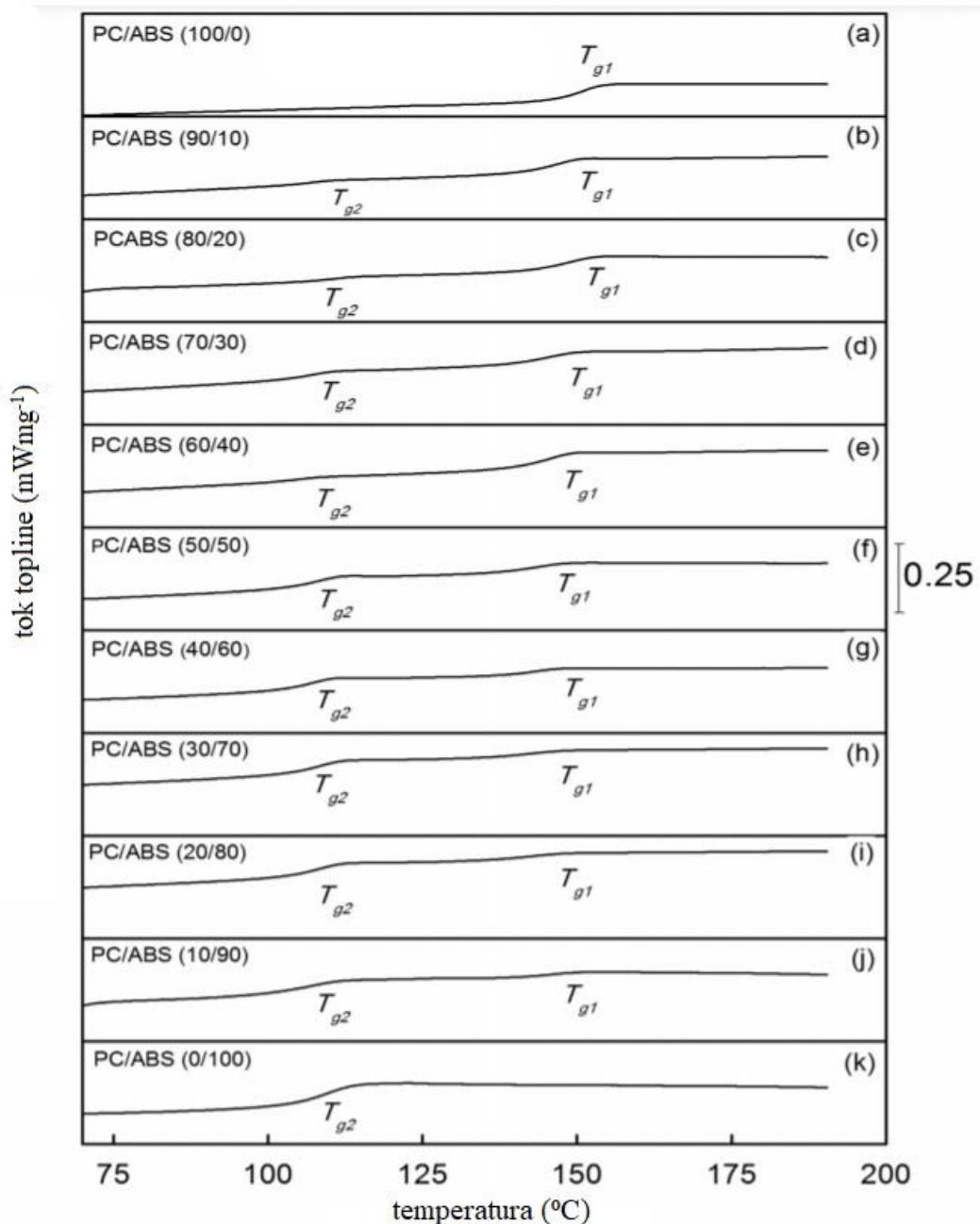
**Slika 44.** Grafovi dobiveni diferencijalnom skenirajućom kalorimetrijom, slova od (a) do (k) označavaju uzorke od 1-11<sup>[5]</sup>
