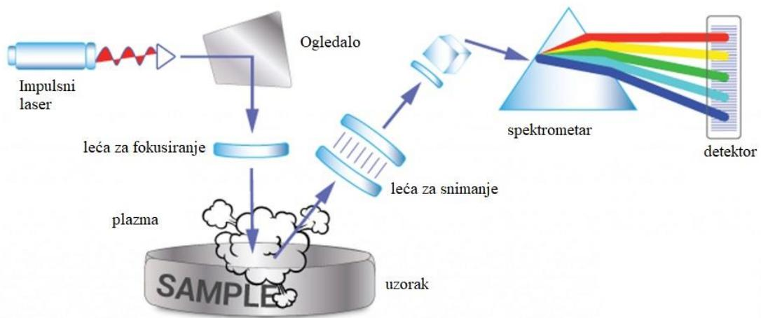
**Slika 4. Pojednostavljeni prikaz LIBS analize<sup>[9]</sup>**
