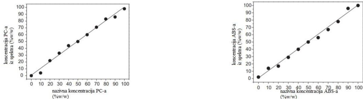
**Slika 43. Usporedba dobivenih koncentracija s nazivnim koncentracijama PC-a i ABS-a u prethodno pripremljenim uzorcima njihovih mješavina<sup>[5]</sup>**
