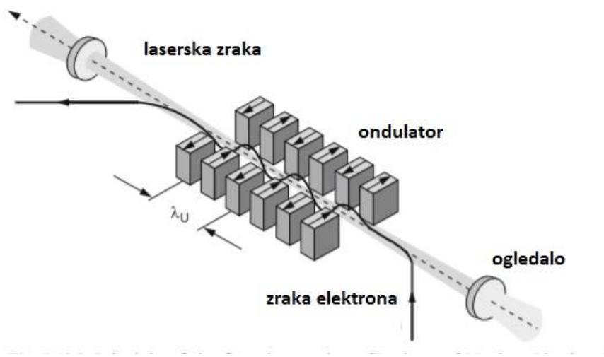
Slika 28. Shematski prikaz rada lasera sa slobodnim elektronima<sup>[10]</sup>
