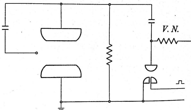
**Slika 21.** Shematski prikaz impulsnog  $CO_2$  lasera s transverzalnom pobudom.<sup>[10]</sup>
