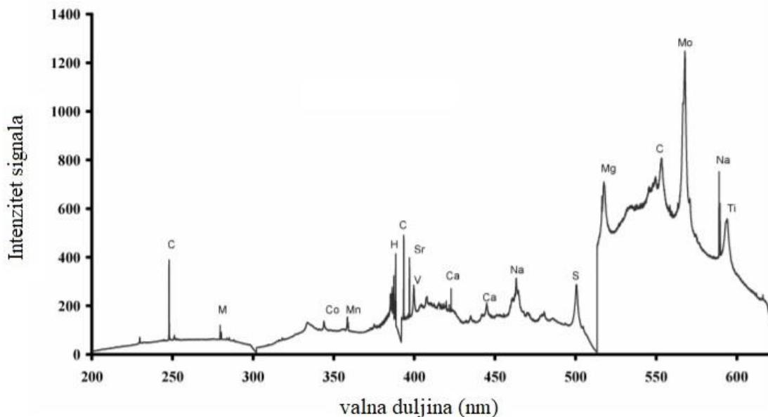
Slika 38. Spektar laserom inducirane probajne spektroskopije PET-a<sup>[4]</sup>
