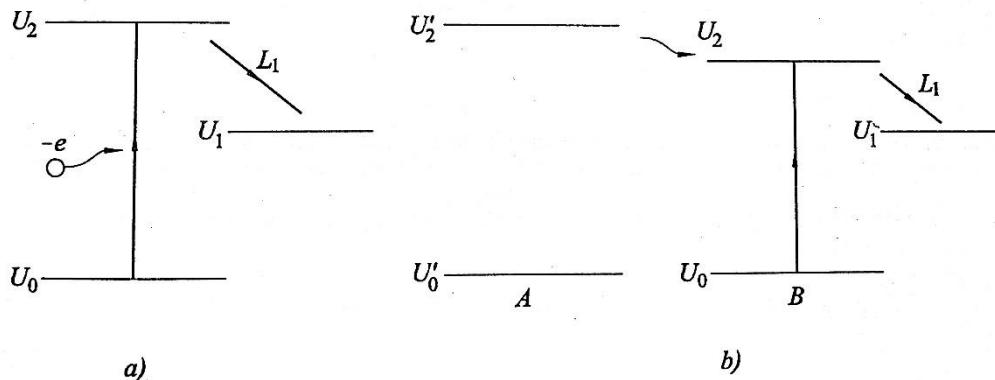
**Slika 12. Inverzija naseljenosti a) elektronskom pobudom i b) srazom drugog reda<sup>[10]</sup>**
