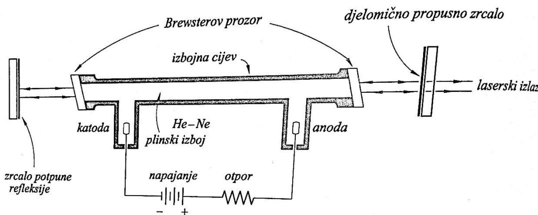
Slika 18. Shematski prikaz He-Ne lasera<sup>[10]</sup>
