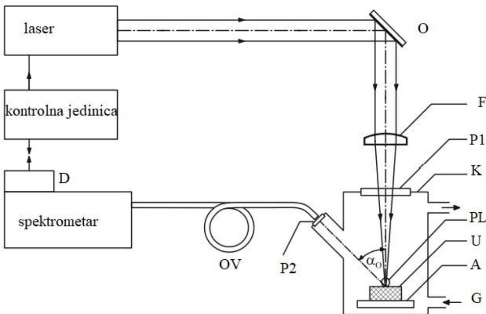
**Slika 34. Aparatura za spektroskopiju laserom inducirane plazme. O – ogledalo, F-leća za fokusiranje, P1- prozor za zraku lasera, K – komora za mjerjenje, PL – laserom pobuđena plazma, U – uzorak, A – pokretna traka, G – otvor za plin,  $\alpha_0$  – kut gledanja, P2 – prozor za mjerjenje plazme, OV – optička vlakna, D – detektori<sup>[13]</sup>**
