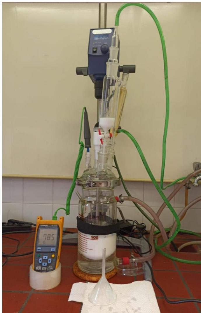
*Slika 10.* Aparatura za proces emulzijske polimerizacije
