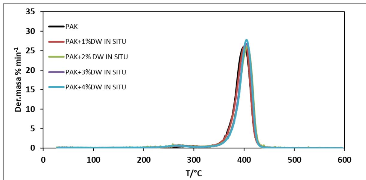
*Slika 36.* DTG krivulje PAK i PAK/TiO<sub>2</sub> filmova pripravljenih iz *in situ* dobivenih emulzija
