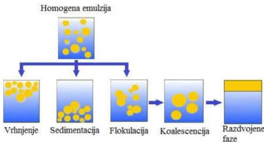
*Slika 5. Mehanizmi destabilizacije emulzije [19]*
