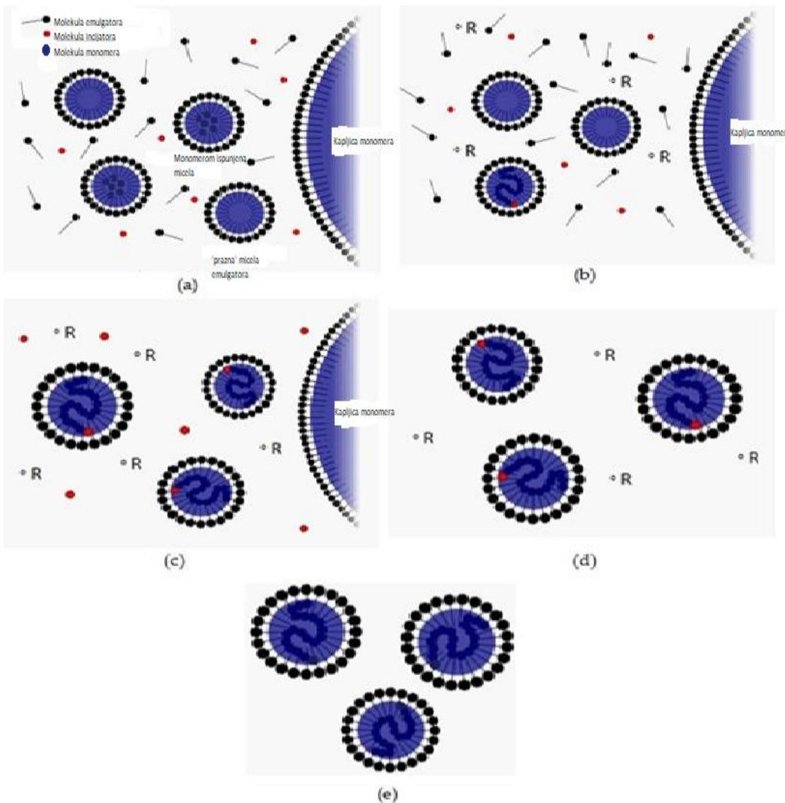
Slika 4. Shematski prikaz mehanizma emulzijske polimerizacije [4]
