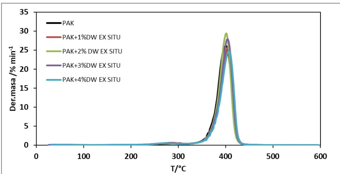
Slika 37. DTG krivulja PAK i PAK/TiO<sub>2</sub> filmova pripravljenih iz *ex situ* emulzijskih polimerizacija
