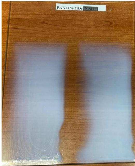
Slika 27. PAK + 1% TiO<sub>2</sub> *in situ*
