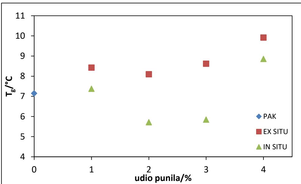
Slika 35. Ovisnost temperature staklišta o udjelu  $\text{TiO}_2$  punila
