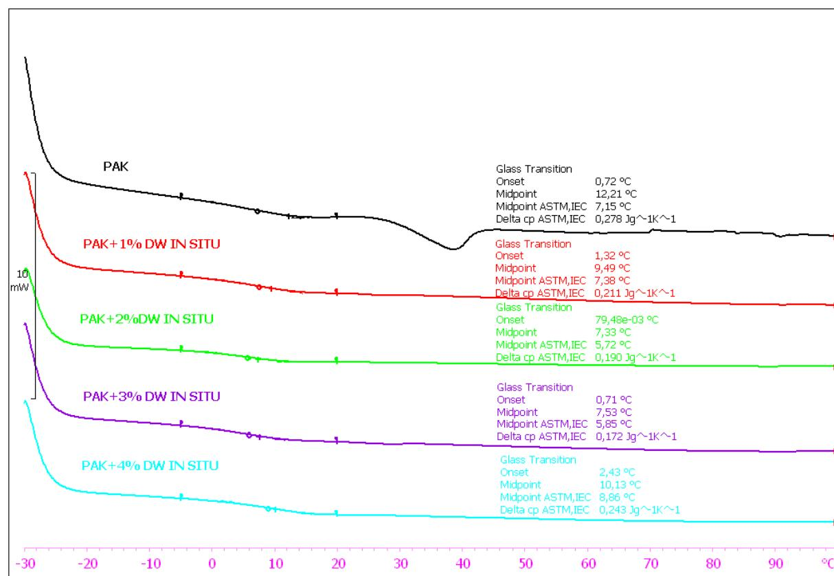
*Slika 33.* DSC termogrami PAK i PAK/TiO<sub>2</sub> filmova dobivenih *in situ* polimerizacijom
