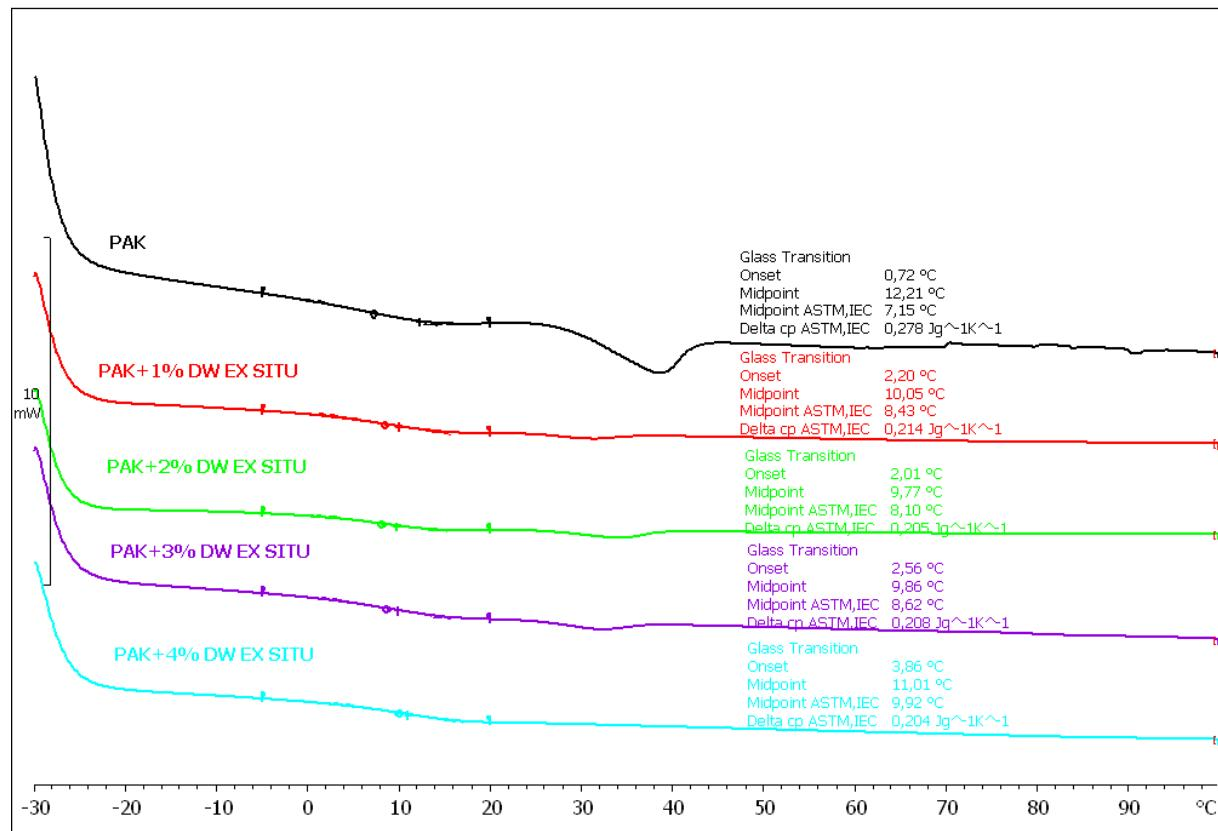
Slika 34. DSC termogrami PAK i PAK/TiO<sub>2</sub> filmova dobiveni *ex situ* polimerizacijom
