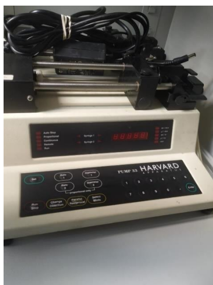
Slika 12. Pumpa Pump33 (Harvard Apparatus) i mikroreaktor u metalnom kućištu
