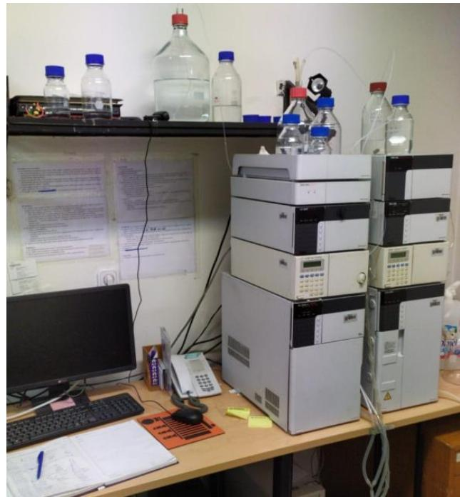
**Slika 13.** HPLC s UV detektorom, Shimadzu (Japan).
