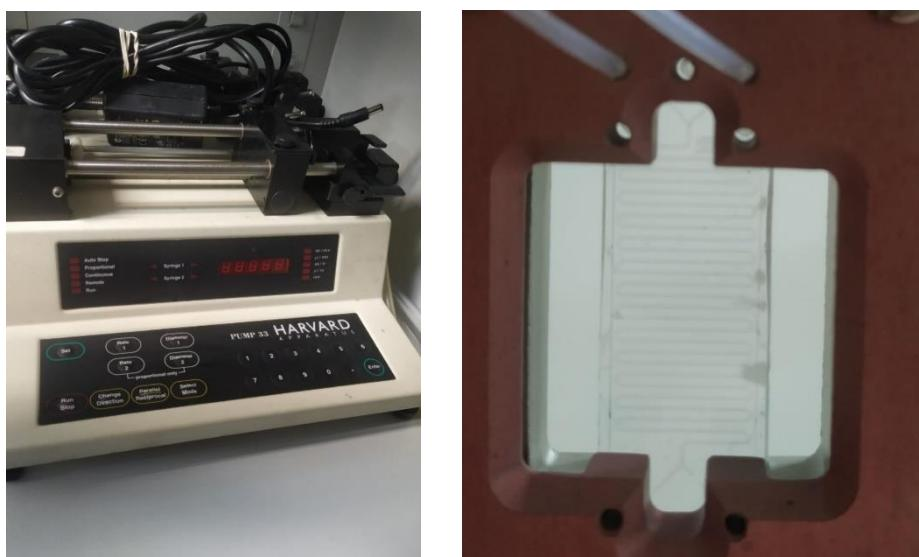
Slika 12. Puma Pump33 (Harvard Apparatus) i mikroreaktor u metalnom kućištu
