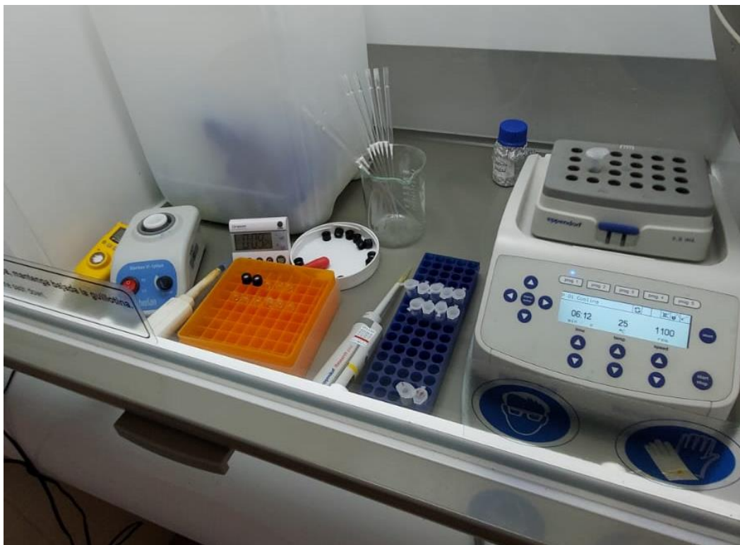
Slika 15. Aparatura za provođenje reakcije u kotlastom reaktoru
