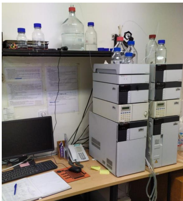
Slika 13. HPLC s UV detektorom, Shimadzu (Japan).
