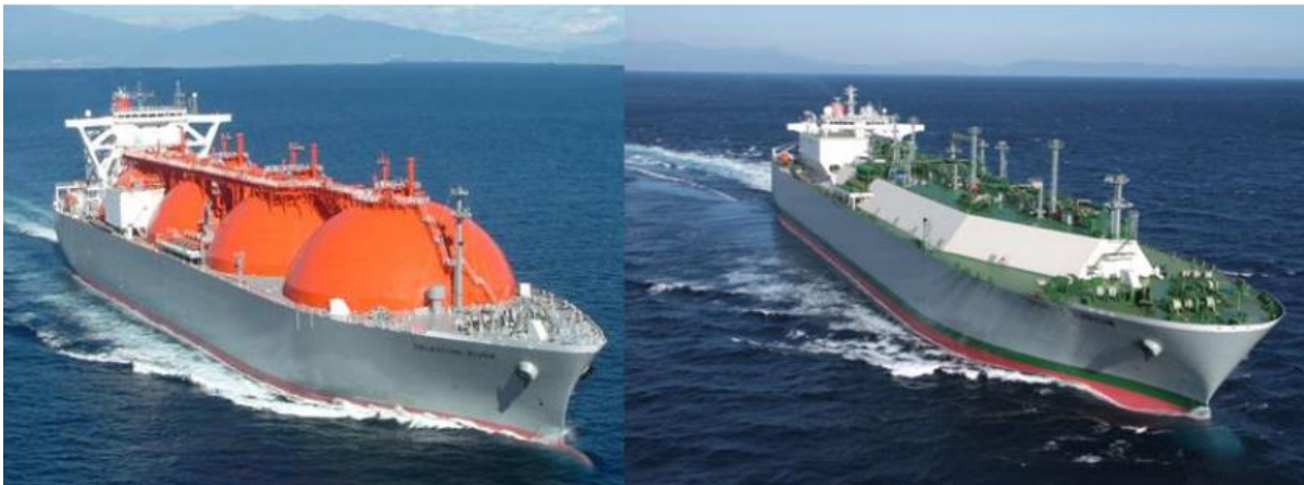
Slika 2. vizualna usporedba LNG tankera sa nezavisnim (lijevo) i membranskim (desno) spremnicima
