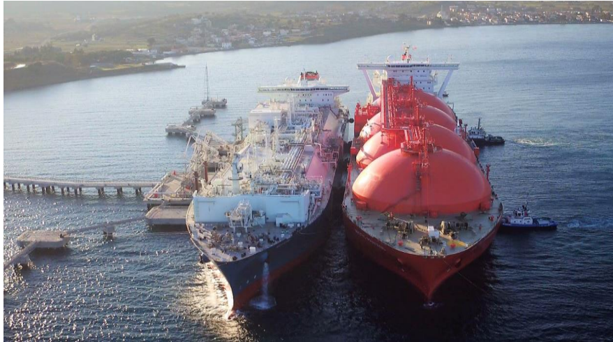
Slika 4. LNG terminal na moru; FSRU
