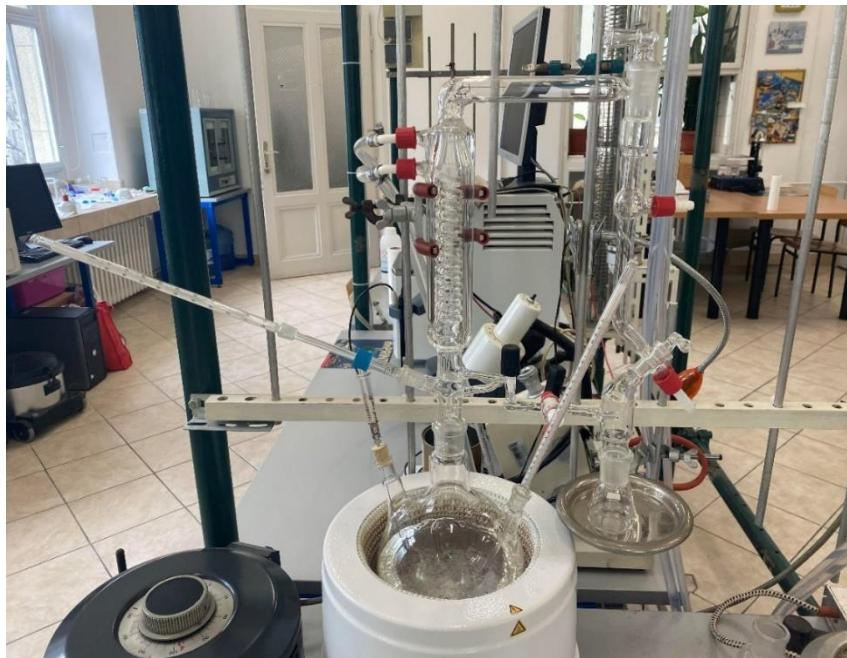
Slika 15. Destilacijska kolona za šaržnu destilaciju
