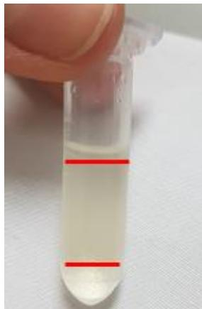
**Slika 11.** Slojevi u uzorku za određivanje aktivnosti komercijalnog enzima lipaza nakon centrifugiranja
