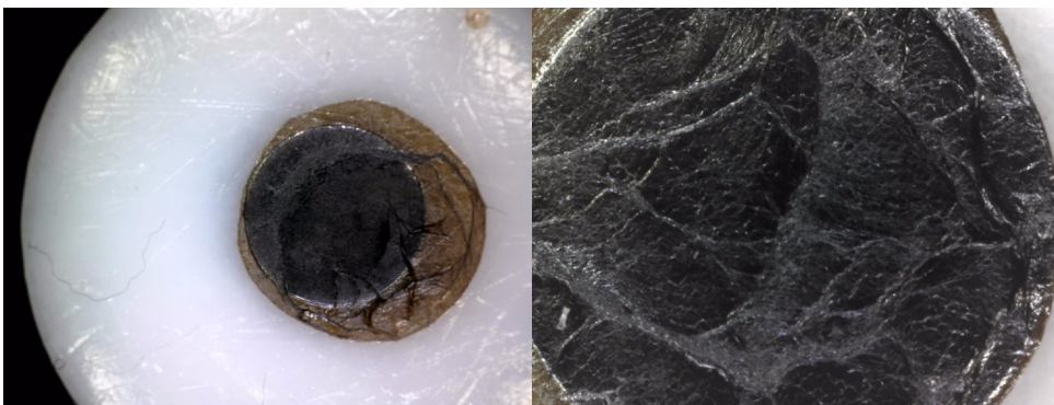
Slika 4.15. Površina GC elektrode na koju je nanesen sloj GO
