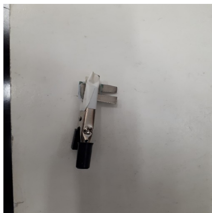
Slika 3.9. rGO papir/rGO papir hibridni superkondenzator
