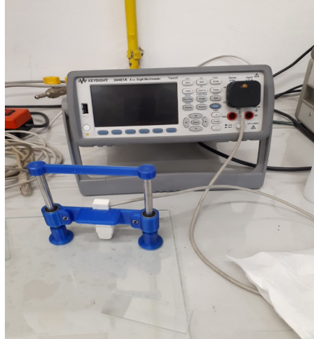
Slika 3.8. Uređaj za mjerenje otpora rGO papira
