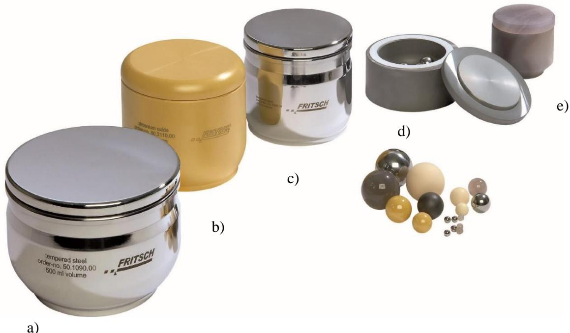
Slika 7. Posude i kuglice za mljevenje različitih materijala i veličina: a) kaljeni čelik, b) cirkonijev oksid, c) nehrđajući čelik, d) volframov karbid, e) ahat [24]
