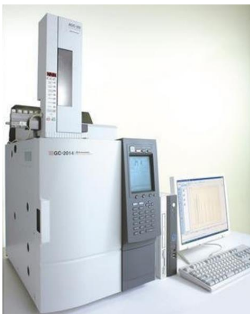
Slika 14. GC – 2014, Shimadzu kolona Carbowax 20M [39]
