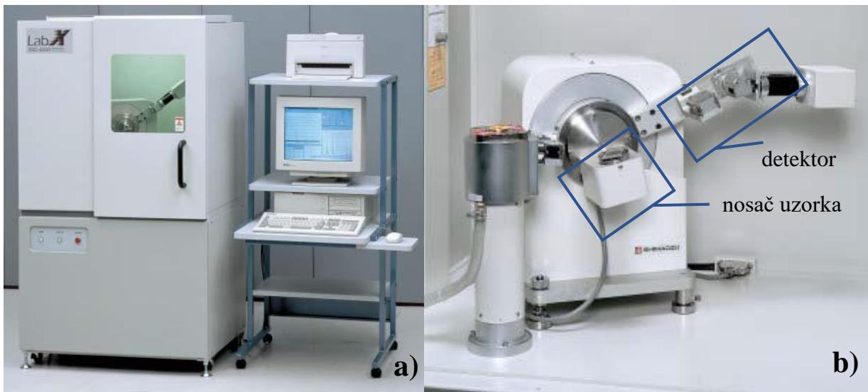
Slika 10. a) Rendgenski difraktometar Shimatzu XRD 6000 b) Okomiti goniometar visoke preciznosti [28]
