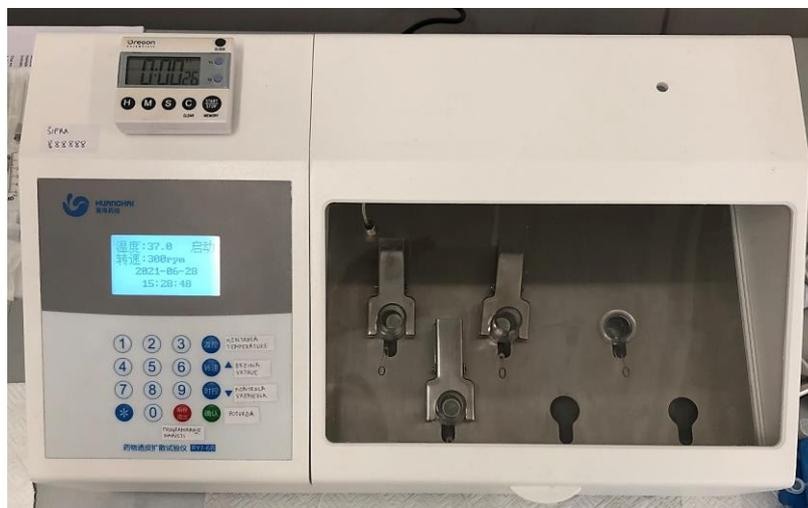
**Slika 7.** Fotografija ispitivača RYJ-68, Xiangtan Xiangyi Instrument Limited.
