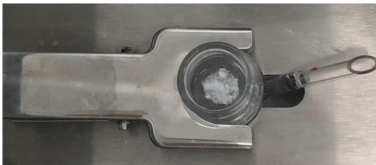
Slika 6. Fotografija transdermalnog pripravka u Franzovoj ćeliji na početku ispitivanja.
