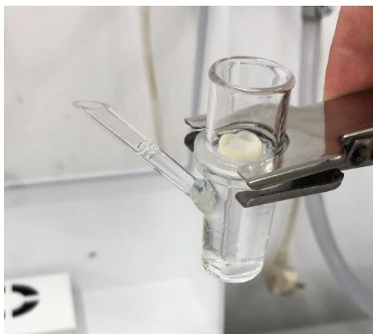
**Slika 8.** Fotografija pripremljene Franzove difuzijske ćelije.
