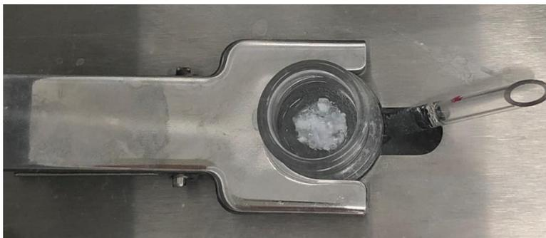
**Slika 6.** Fotografija transdermalnog pripravka u Franzovoj ćeliji na početku ispitivanja.
