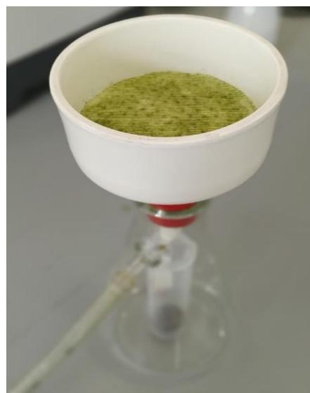
Slika 16. Filtriranje otapala pomoću Büchnerova lijevka i vakuum pumpe
