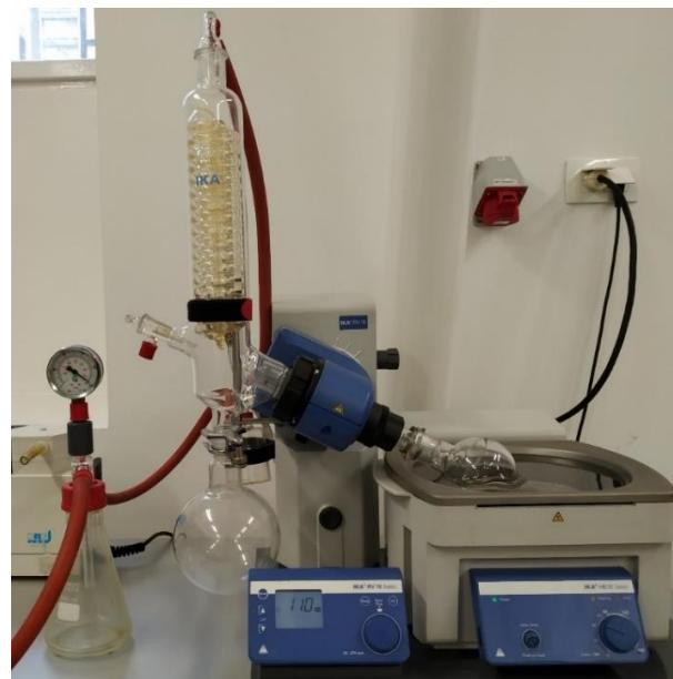
Slika 10. Zagrijavanje i miješanje otapala na uređaju *IKA RV 10 Basic rotary evaporator*.
