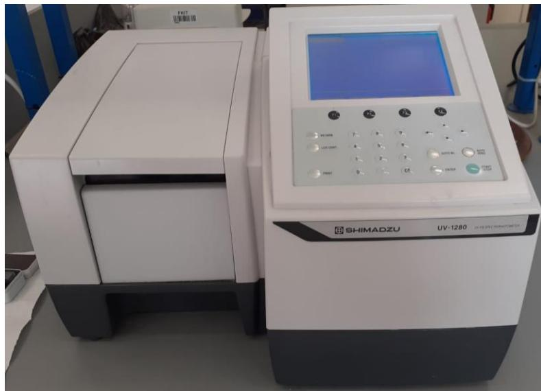
Slika 18. *Shimadzu* spektrofotometar *UV-1280*
