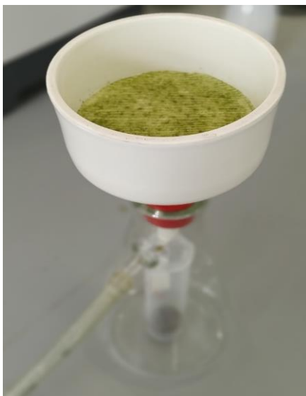
Slika 16. Filtriranje otopala pomoću Büchnerova lijevka i vakuum pumpe
