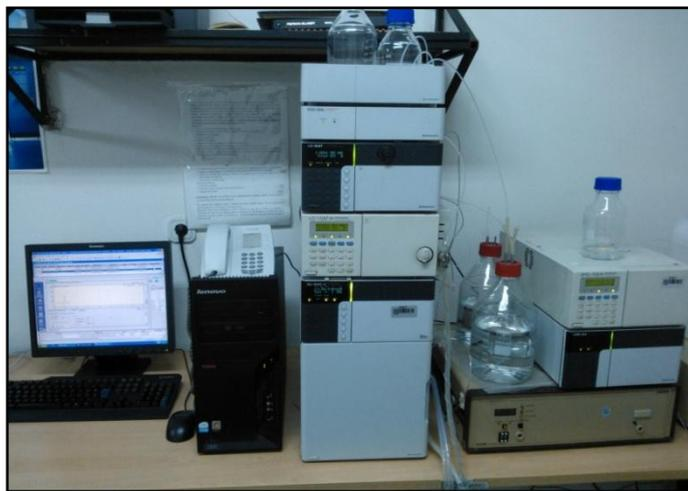
Slika 3.4 HPLC Shimadzu modularni sustav
