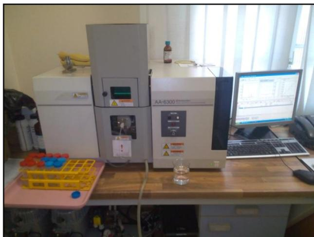
Slika 3.5 Atomski apsorpcijski spektrometar Shimadzu AA-6300
