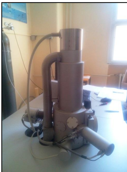
Slika 3.8 SEM Tescan Vega III Easyprobe
