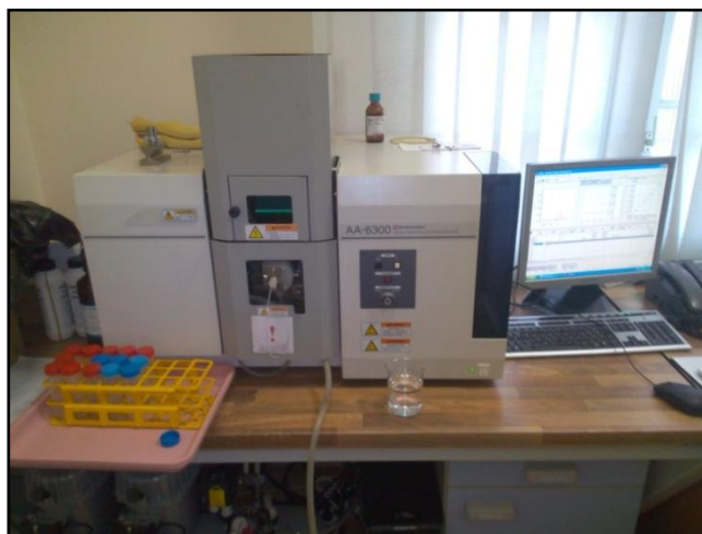
Slika 3.5 Atomski apsorpcijski spektrometar Shimadzu AA-6300
