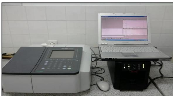
Slika 3.3 Spektrofotometar Shimadzu UV-1800
