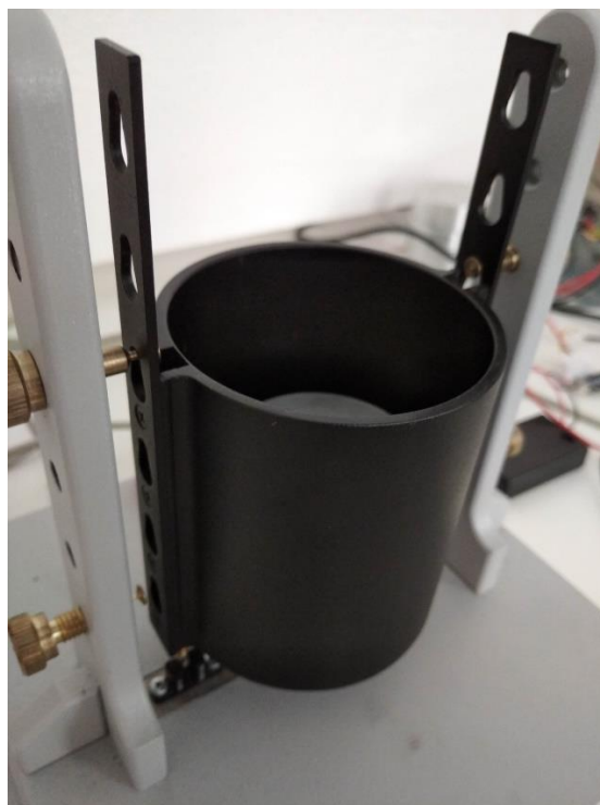
Slika 8. Prikaz osi titranja u izvedenoj aparaturi. Trenutno je nosač uzorka (s aluminijskom slinom koja nije bila korištena kao uzorak u ovome nizu mjerenja) ovješén oko treće osi, brojeći od vrha.
