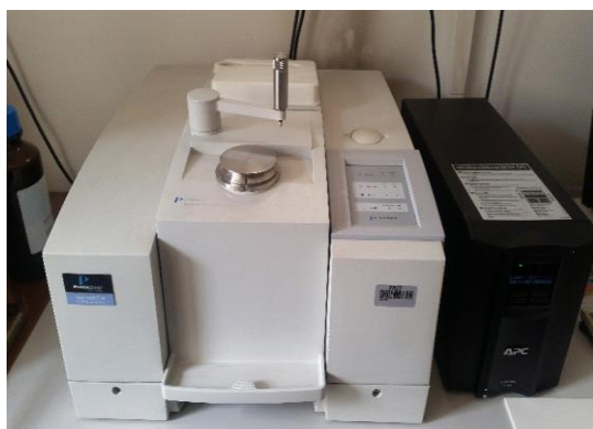
Slika 23. FTIR-ATR spektrofotometar Spectrum One, Perkin Elmer.
