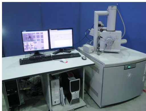
Slika 25. Pretražni elektronski mikroskop SEM QUANTA 250, FEI.
