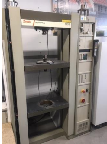
Slika 24. Mehanička kidalica Zwick 1455.
