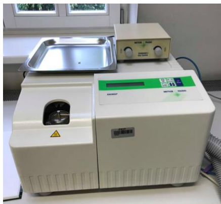
Slika 22. DSC analizator 822°, Mettler Toledo.
