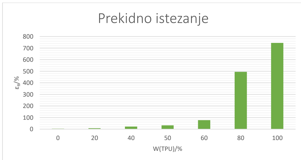
Slika 36. Ovisnost prekidnog istezanja o masenom udjelu TPU u PLA/TPU mješavinama.
