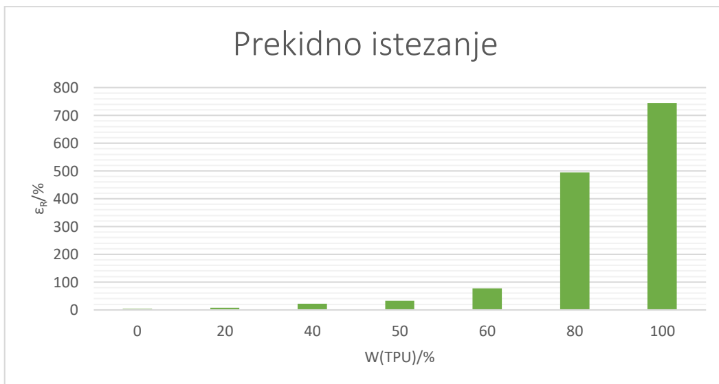
Slika 36. Ovisnost prekidnog istezanja o masenom udjelu TPU u PLA/TPU mješavinama.
