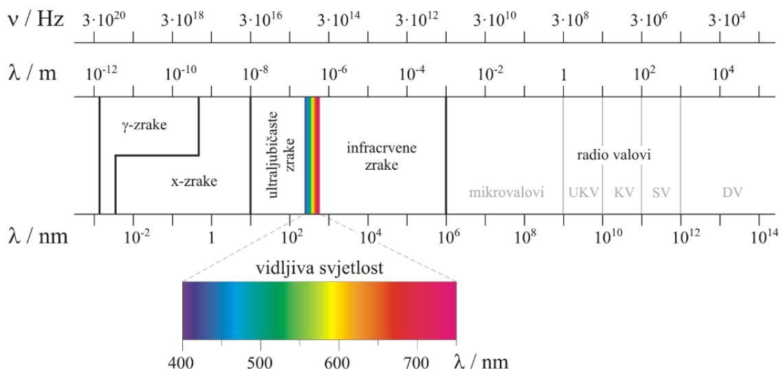
Slika 14. Elektromagnetski spektar.
