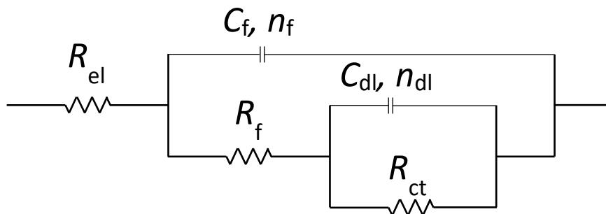
**Slika 21.** Ekvivalentni strujni krug korišten pri mjerenu neozračenih i odabranih ozračenih uzoraka (tablica 4).
