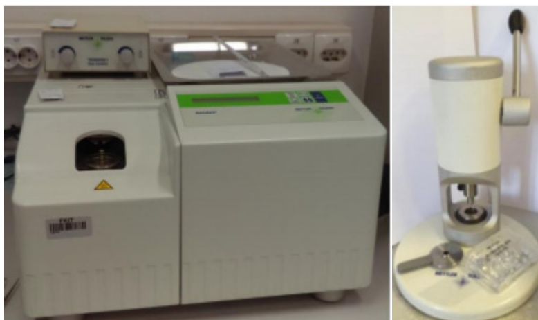
Slika 21. DSC uređaj Mettler Toledo DSC 823 (lijevo) i preša (desno)
