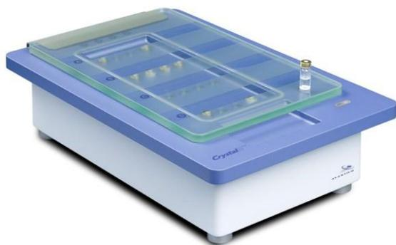
Slika 3.1. Uređaj *Crystal 16* korišten za određivanje širine metastabilne zone<sup>14</sup>
