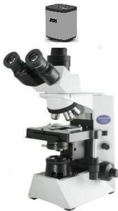
Slika 3.7. Svjetlosni mikroskop *Olympus CX31*<sup>17</sup>
