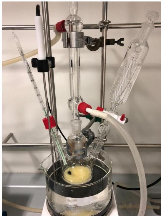
Slika 3.3. Aparatura za određivanje potencijalnih antiotapala
