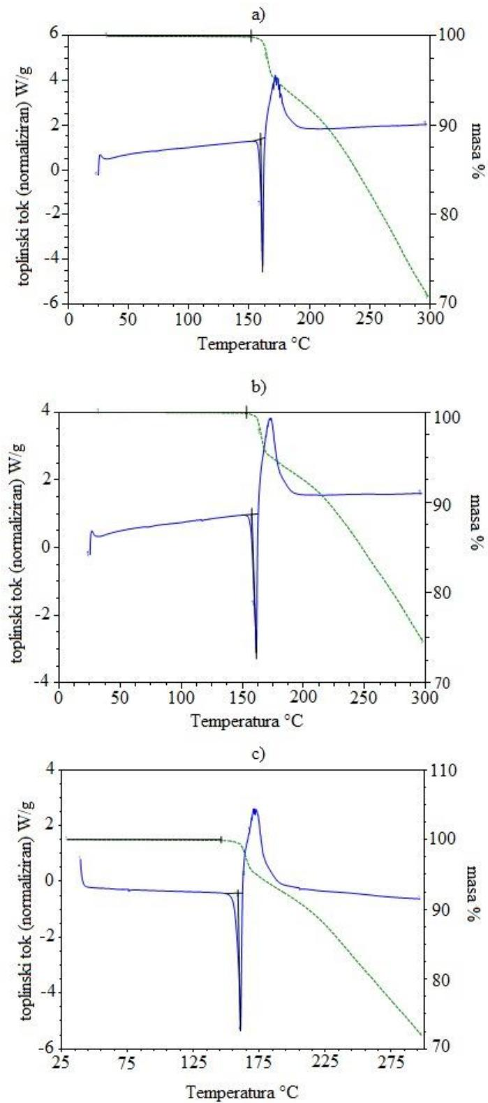
Slika 4.18. DSC i TG krivulje za različite brzine dokapavanja vode a) naglo izljevanje, b) 3,25 ml/min i c) 0,5 ml/min
