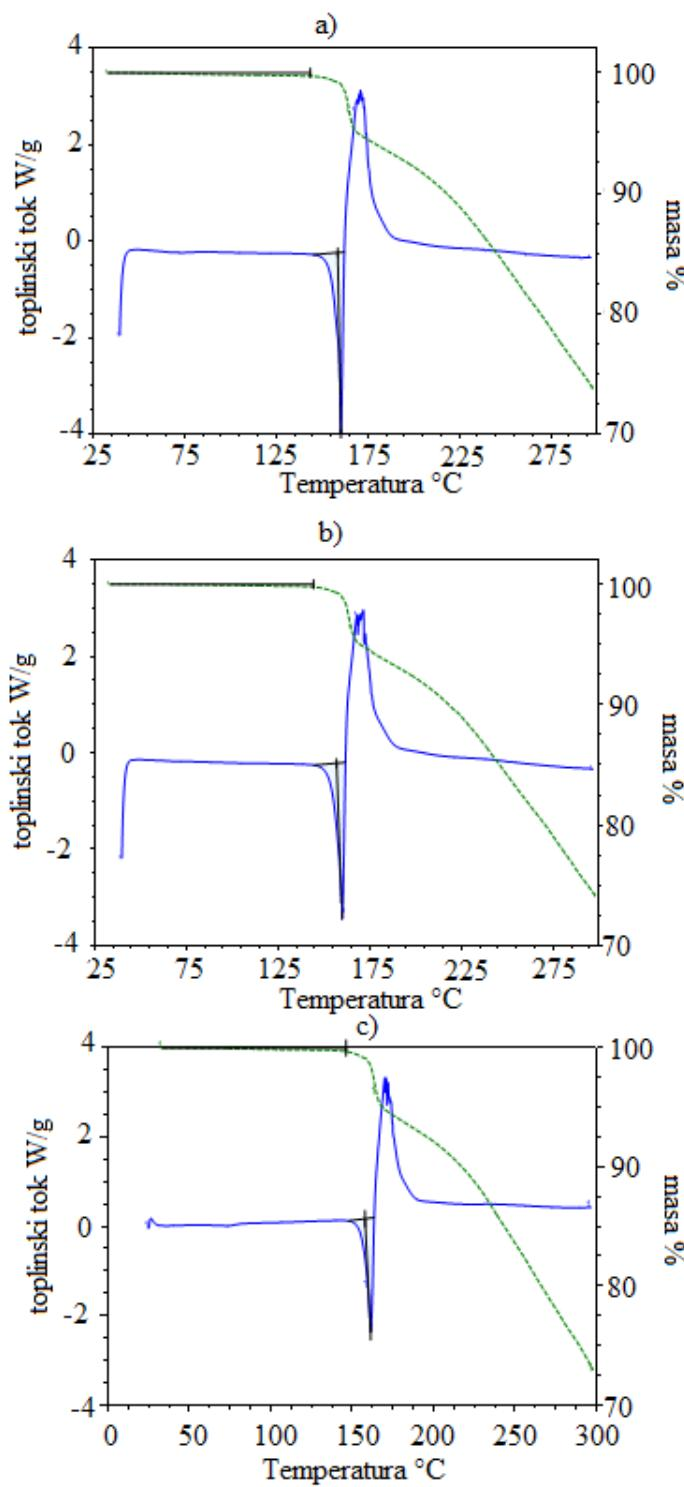
Slika 4.19. DSC i TG krivulje za različite brzine dokapavanja MTBE: a) naglo izlijevanje,
