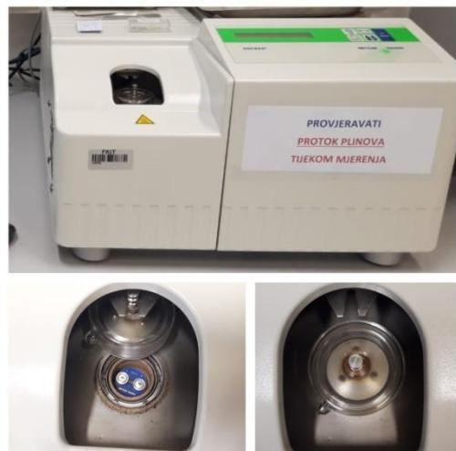
Slika 23. DSC uređaj, Mettler Toledo DSC 823e
