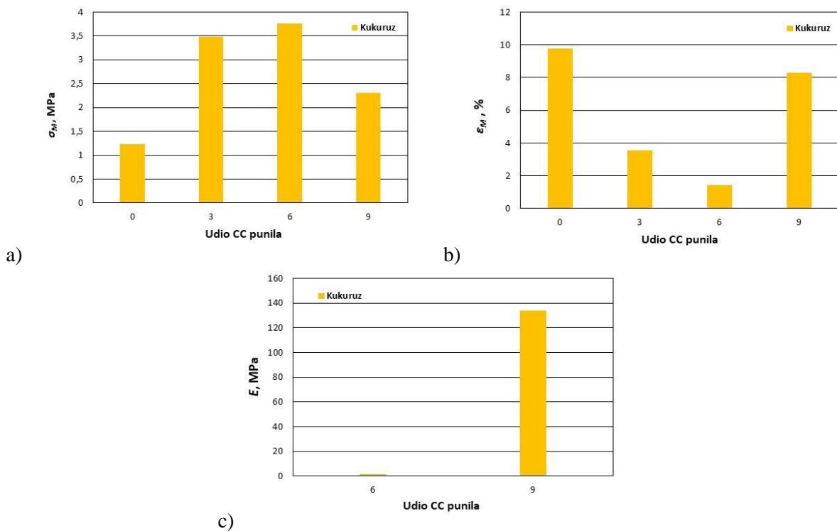
Slika 45. Ovisnost prekidne čvrstoće a) prekidnog istezanja b) i rasteznog modula c) TPS C (kukuruz) kompozita o udjelu punila CC
