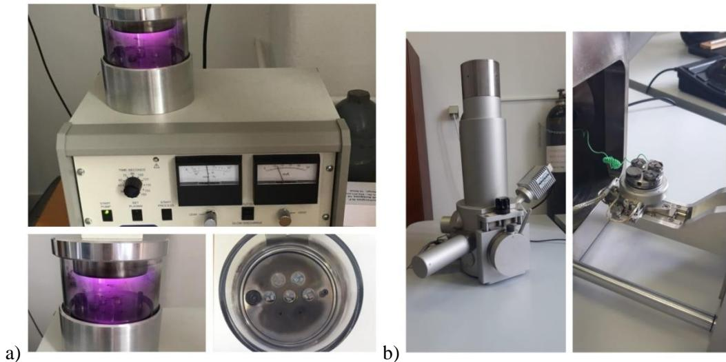
Slika 26. Uređaj za naparivanje uzoraka i SEM uređaj Tescan Vega 3, Bruker
