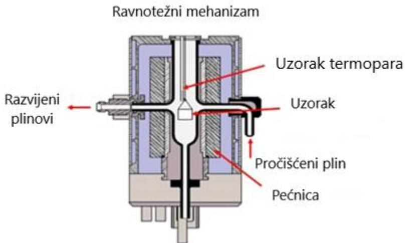
Slika 11. Shematski prikaz osnovnog dijela TGA uređaja [34]
