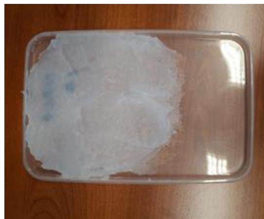
Slika 19. Film dobiven lijevanjem otopine
