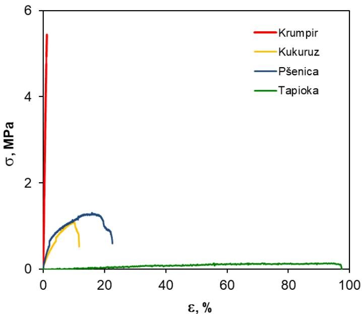
Slika 40. Usporedne krivulje naprezanje-istezanje TPS filmova pripravljenih od različitih vrsta škroba (C, W, T i P)
