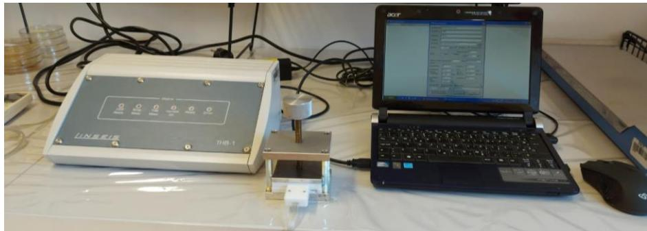
Slika 25. Uređaj za mjerjenje toplinske vodljivosti Linseis THB-1
