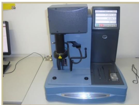
Slika 24. Termogravimetar, TA Instruments Q500
