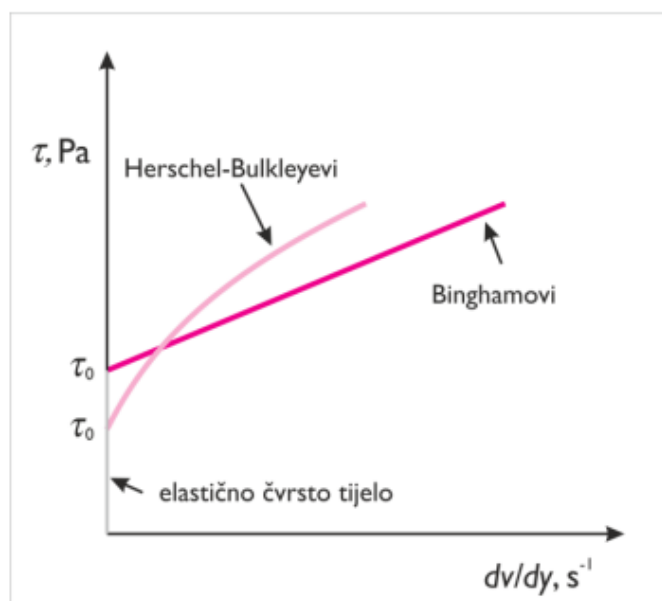
Slika 9. Reološki dijagram viskoelastičnih kapljevin 4
