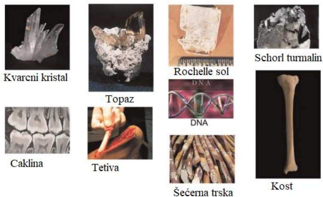
Slika 19. Neki prirodni piezoelektrični materijali 23
