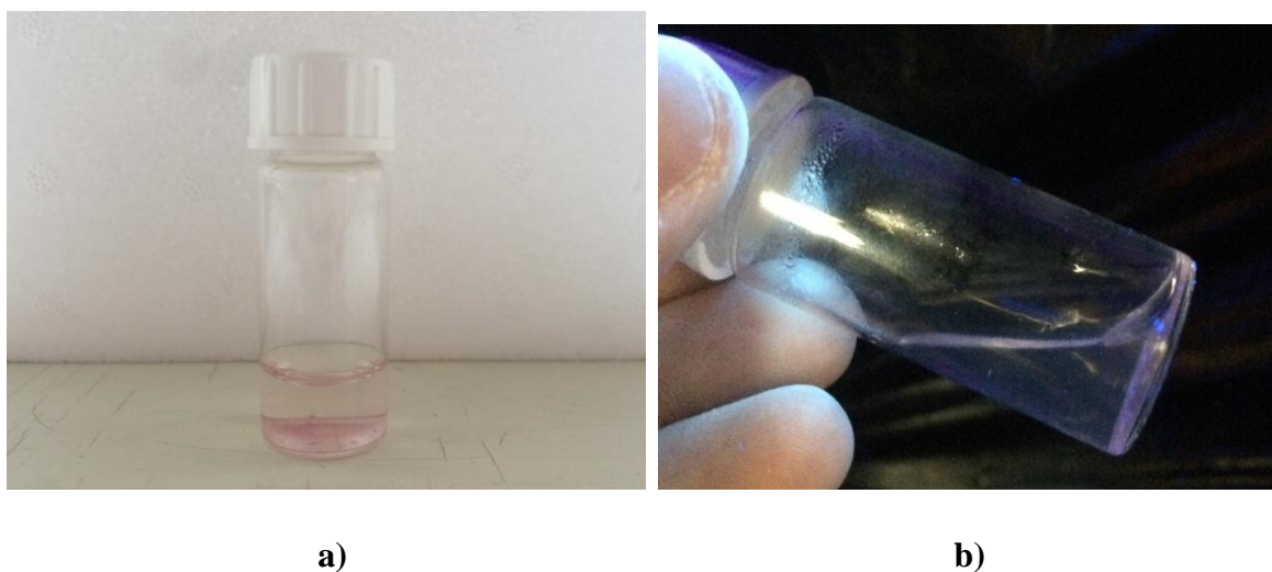
Slika 28. Stock otopina polimernih nanočestica dopiranih lipofiliziranim Nile Blue bojilom na danjem svjetlu (a); Stock otopina polimernih nanočestica dopiranih Nile Blue bojilom pod UV lampom (b)
