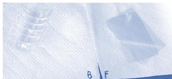
**Slika 3.1.** Komercijalni uzorci PET boca (B) i PET folija (F) pripremljeni za toplinsko starenje
