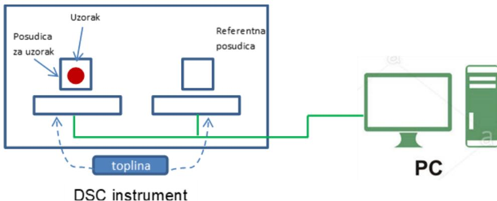
**Slika 2.6.** Shema uređaja korišten za DSC analizu.
