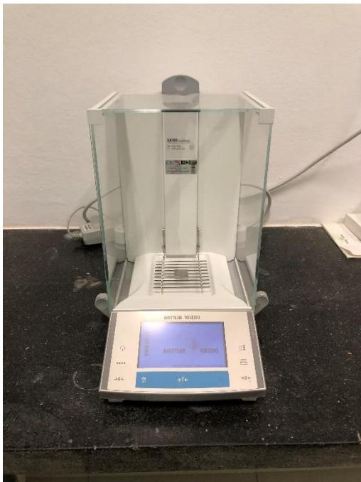
**Slika 5.** Analitička vaga XS105 DualRange, Mettler Toledo
