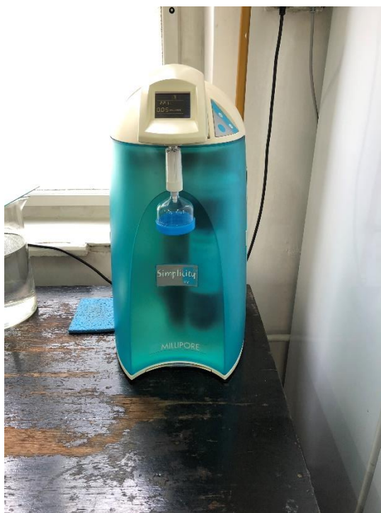
Slika 4. Uređaj za pročišćavanje vode Millipore Simplicity
