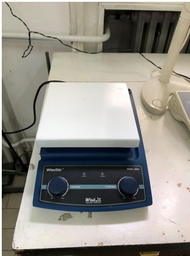
Slika 8. Magnetska miješalica WiseStir MSH-20D , Witeg
