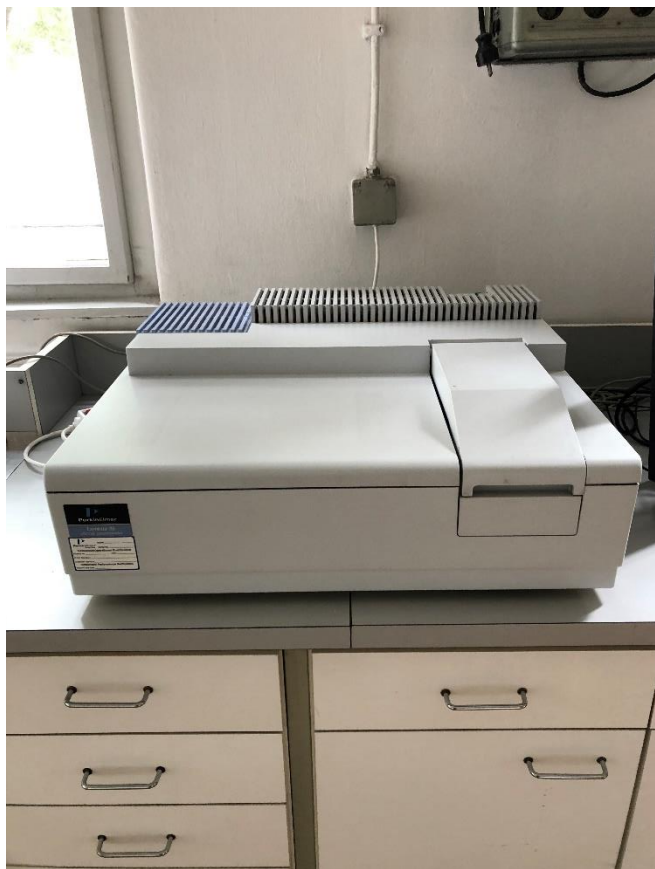
Slika 7. Lambda 35 UV/VIS spectrometer, PerkinElmer
