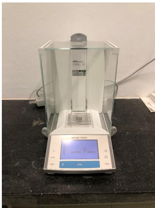
Slika 5. Analitička vaga XS105 DualRange, Mettler Toledo
