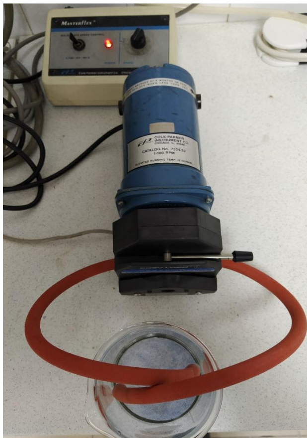
Slika 3.3. Aparatura sa peristaltičkom pumpom i crijevom, sučeljem za namještanje željenog protoka i reaktorom.
