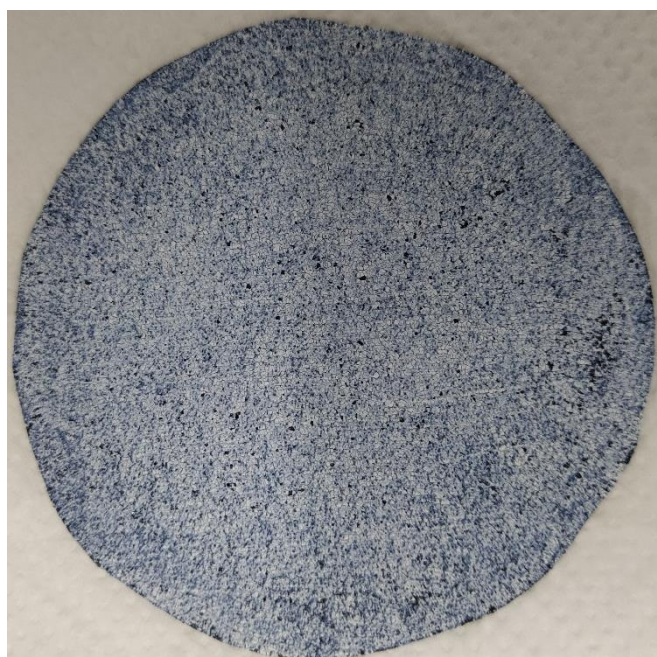
Slika 3.6. Novi katalizator u procesu sušenja
