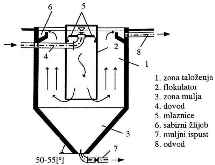
**Slika 11.** Shema taložnika s vertikalnim dovodom vode
