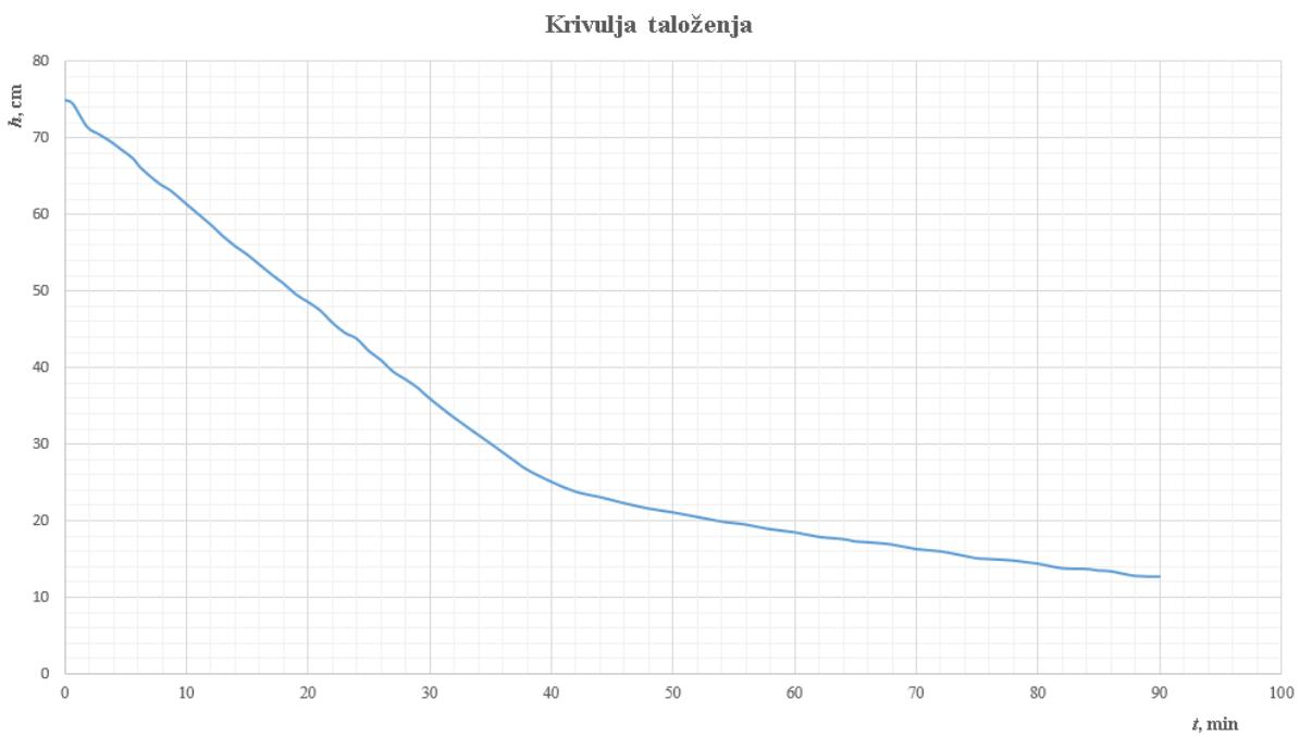
**Slika 14.** Krivulja taloženja ispitivane suspenzije kalcijeva karbonata i vode
