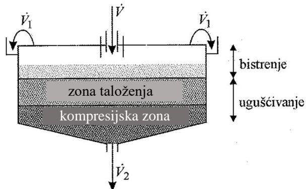
Slika 1. Shematski prikaz karakterističnih zona u kružnom taložniku <sup>[5]</sup>
