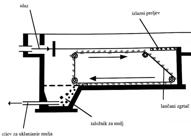
**Slika 9.** Shema pravokutnog taložnika s lančanim zgrtačem<sup>[1]</sup>
